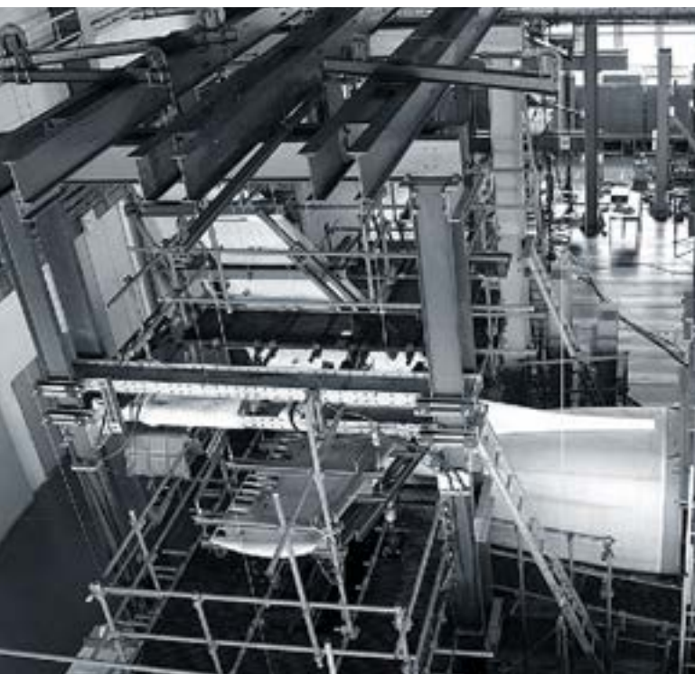
Únavová zkouška zadní části trupu a ocasních ploch L410NG
