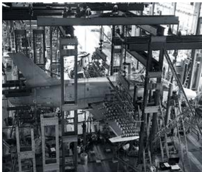
Prototyp L-39NG na statické pevnostní zkoušce
