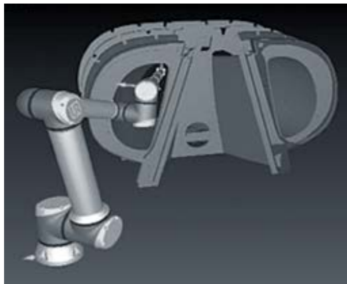
Návrh robotického pracoviště pro NDT
