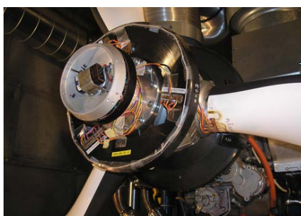
Instrumentace kompozitní vrtule tenzometry a systémem sběru a přenosu dat
