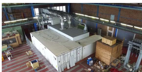
Dynamometrická zkušebna turbovrtulových motorů pro ČVUT
