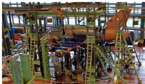
Únavová zkouška křídla letounu AJT
