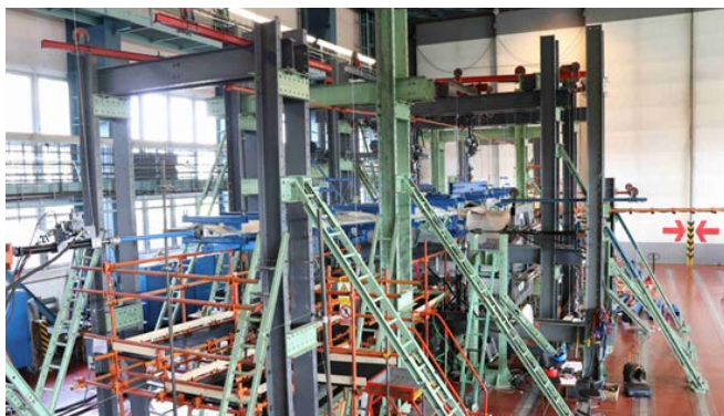
Stend únavové zkoušky křídla a střední části trupu L410NG
