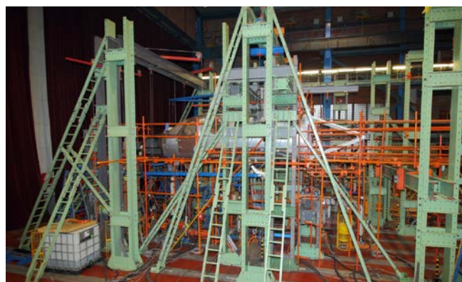
5. Statická zkouška trupu EV-55
