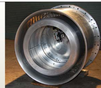
7. Návrh a realizace zařízení umožňující variantní studium vlivu vstupních charakteristik proudu do axiálního turbínového stupně na zkušebním stavu VZLÚ.
