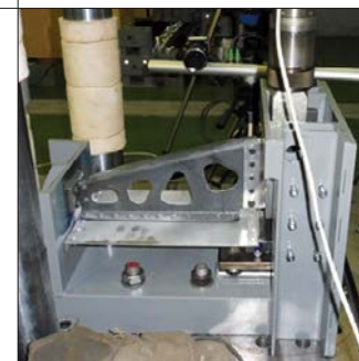
14. Ověření návrhu přípravku na MKP modelu a fyzické uspořádání zkoušky termoplastického dílu „Intercostal“
