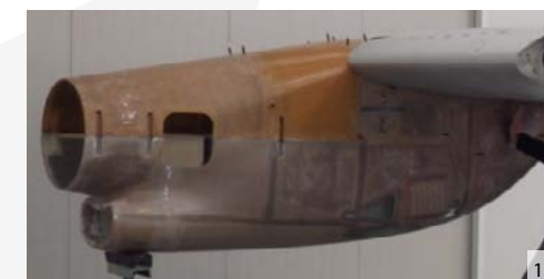
15. Zástavba prototypu kompozitní motorové gondoly na křídlo letounu L-410NG
