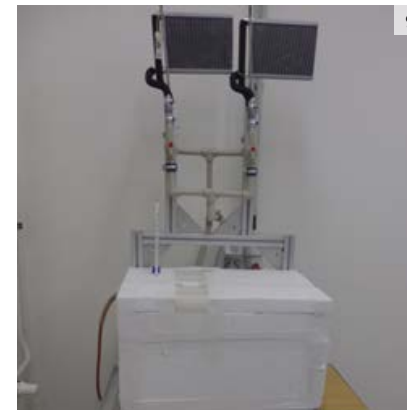
9. Test vnitřní koroze výměníků
