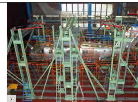
7. Statická zkouška trupu EV-55M
