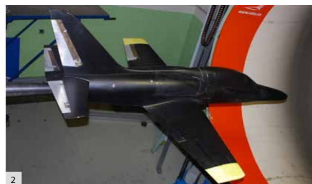
2. Model cvičného proudového letounu v aerodynamickém tunelu
