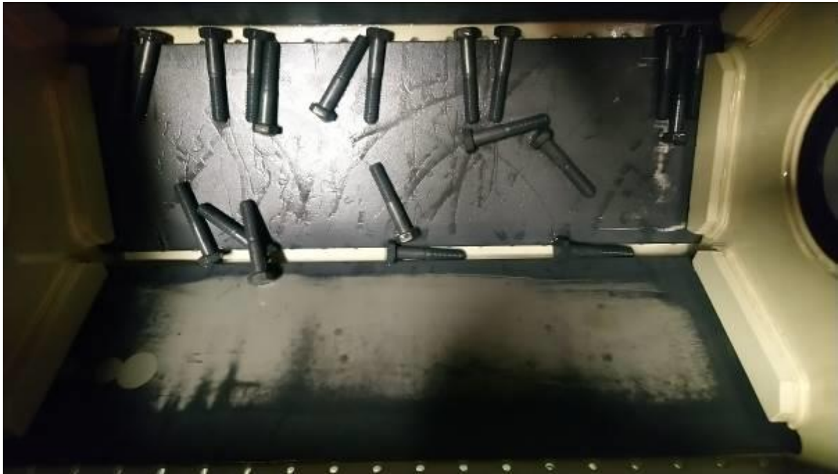
obr. č. 4 KTL lakovací buben s nalakovaným šrouby
