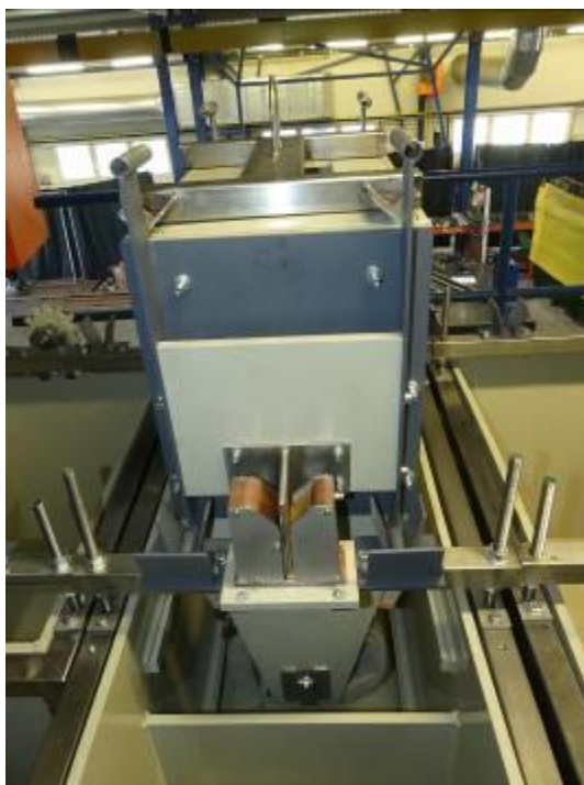
obr. č. 3 KTL lakovací buben včetně el. lůžka a kontaktu
