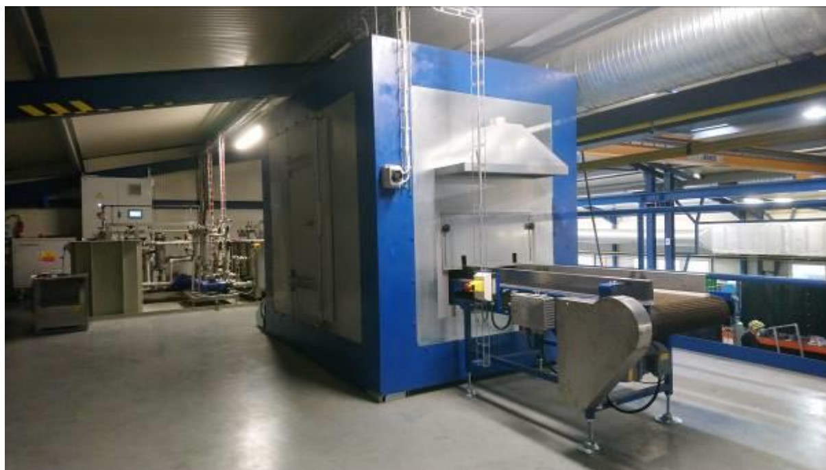
obr. č. 2 Polymerizační pec se speciálním pásovým dopravníkem
