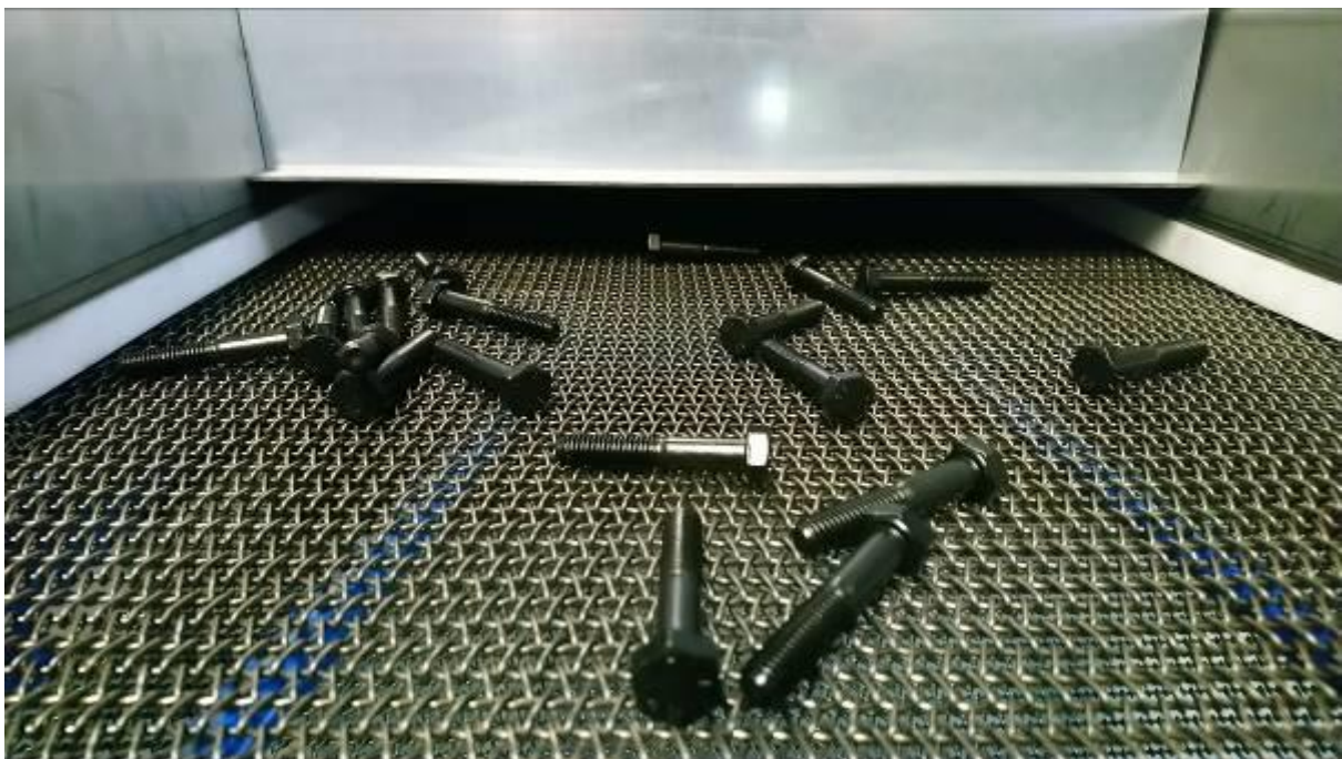
obr. č. 5 KTL drátěný pás polymerizační pece s vypálenými šrouby M8
