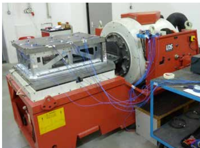
Obrázek 6 - Ukázka vibrační zkoušky sendvičového panelu (Zdroj: VZLÚ)
