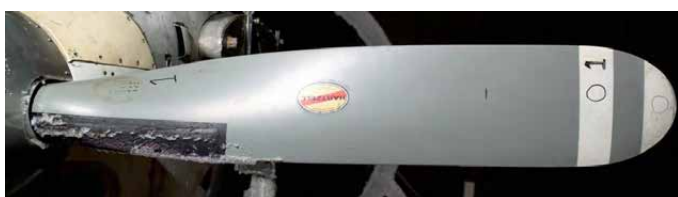
Obrázek 3 - Příklady tvorby námrazy na duralovém listu, převzato z [1]
