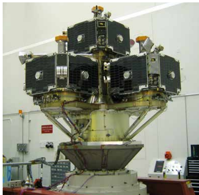
Obrázek 1 - Vibrační zkouška sestavy pěti satelitů THEMIS (Zdroj: NASA)
