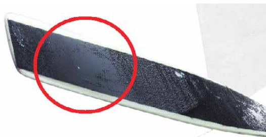
Obrázek 19 - I při zkouškách prototypu WOODCOMP KW-3x bylo zjištěno, že dochází k samovolnému odstranění námrazy na vnější části listu, pod jeho špičkou. Příčinou je zřejmě buzení listu ke kmitání prací pístového motoru a s tím souvisejícím ohřevem částí konstrukce
