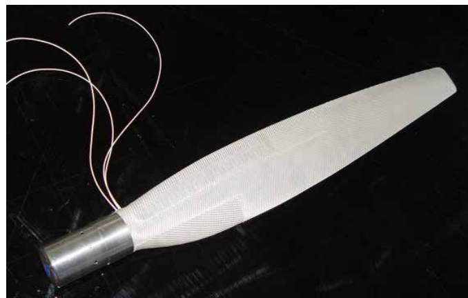
Obrázek 11 - Vrtulový list WOODCOMP, typ "C" před vložením do formy a injektáží pojiva. Výrobní technologie VARTM
