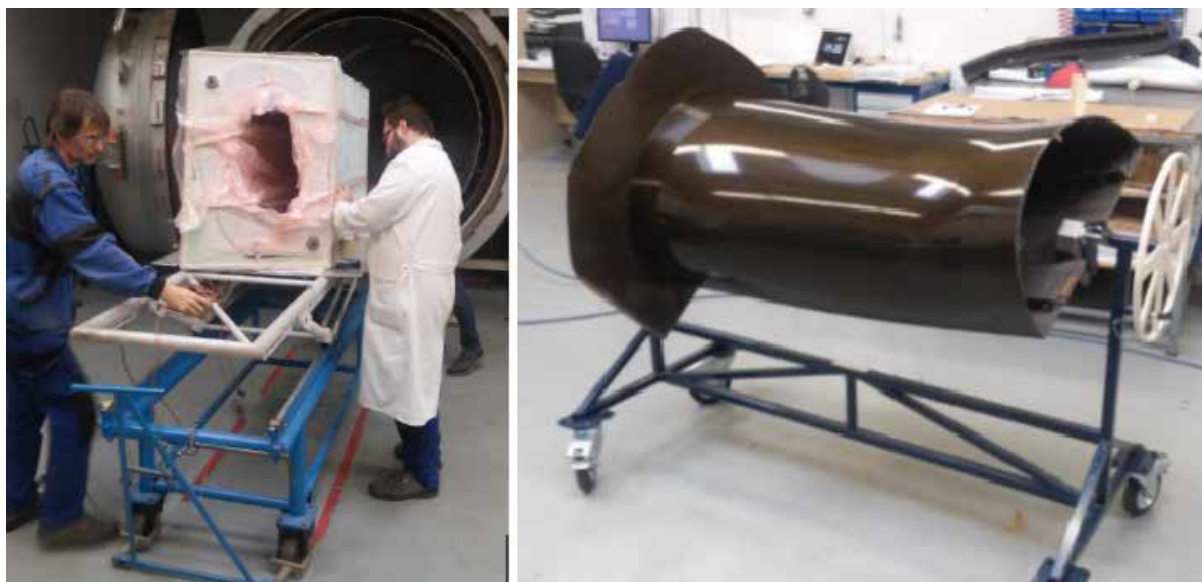
Obrázek 1 - Výroba kompozitní formy demonstrátoru
