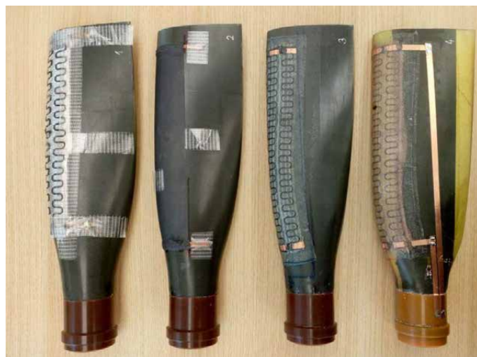
Obrázek 5 - První zkoušky materiálů probíhaly po aplikaci na povrch vzorků vyrobených ze sériových vrtulových listů. Zde se již začaly projevovat výhody a nevýhody z pohledu budoucí sériové výroby
