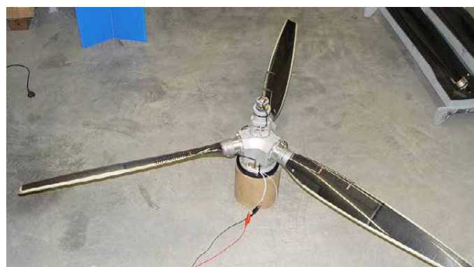
Obrázek 13 - Prototyp WOODCOMP KW-3x připravený k statickým zkouškám funkce systému odmrazování
