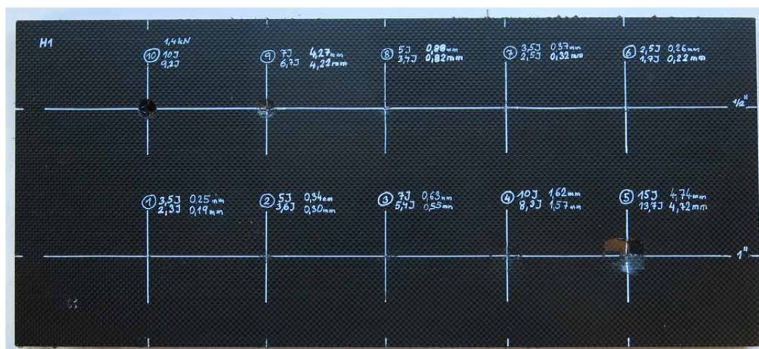
Obrázek 2 - Zkušební panel H1 s BVID a VID poškozeními
