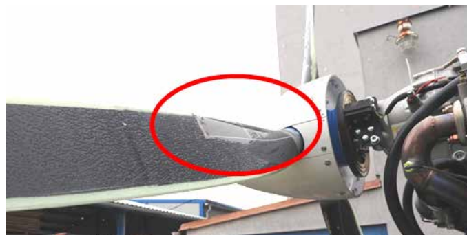
Obrázek 18 - K odstranění námrazy docházelo opakovaně a spolehlivě jak pro samostatně zapojená tělesa, tak pro tělesa pracující v režimu pravidelného přepínání vnitřní/vnější. Tento režim je důležitý pro snížení nároků na výkon zdroje palubní elektrické sítě
