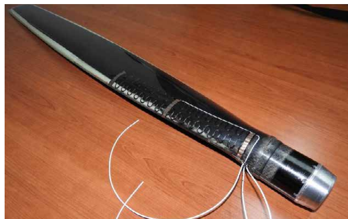
Obrázek 12 - Hotový list po vyjmutí z formy. Topná tělesa je možno zapojovat samostatně i současně
