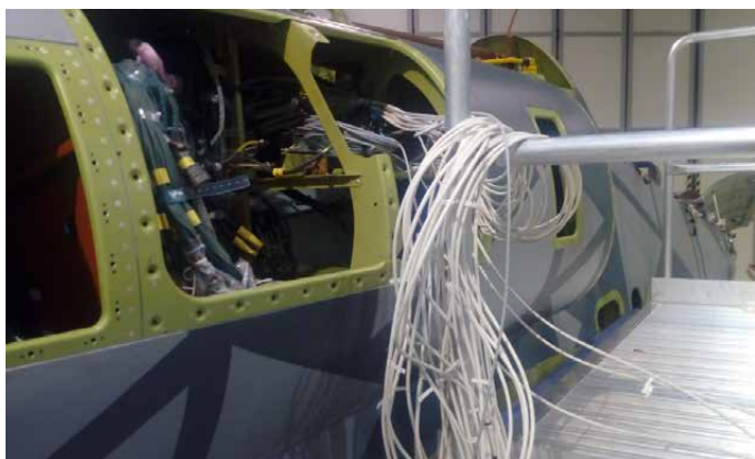
Obrázek 9 - Vyvedení kabeláže tenzometrů na vzduchovodu z trupu letounu
