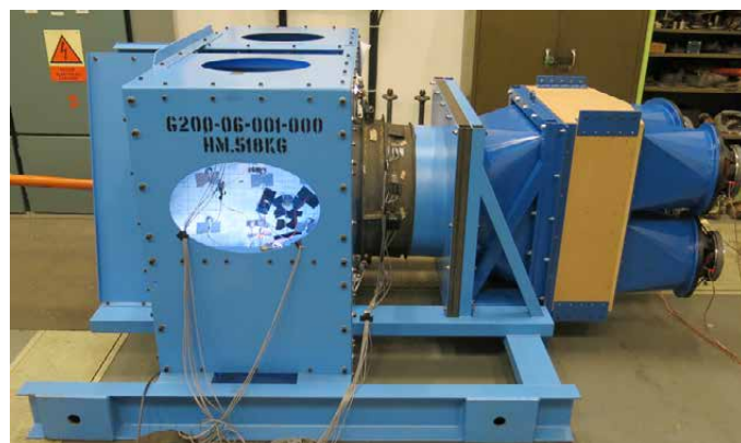
Obrázek 6 - Celkový pohled na zkušební zařízení pro zkoušku akustické únavy demonstrátoru vzduchovodu
