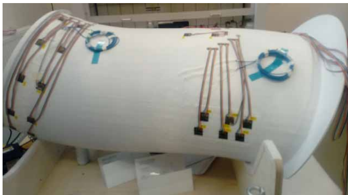
Obrázek 8 - Kanál s měřicími senzory před instalací do letounu
