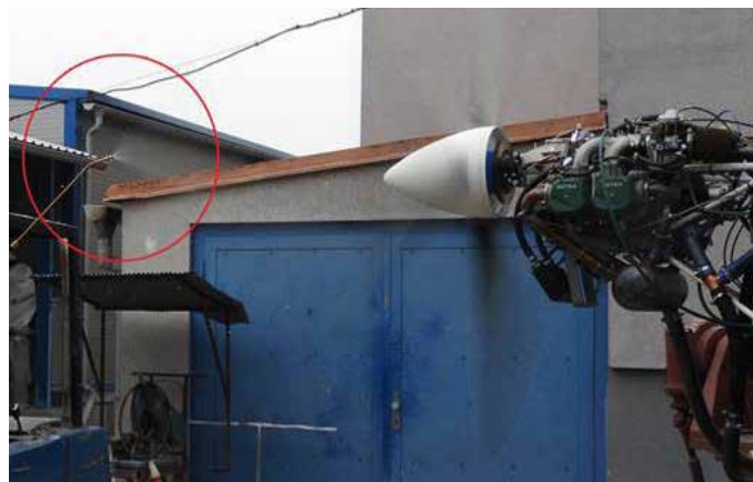
Obrázek 17 - Námraza byla vyvolána vpouštěním vodní mlhy do proudu nabíhajícího vzduchu pomocí ručního rozprašovače
