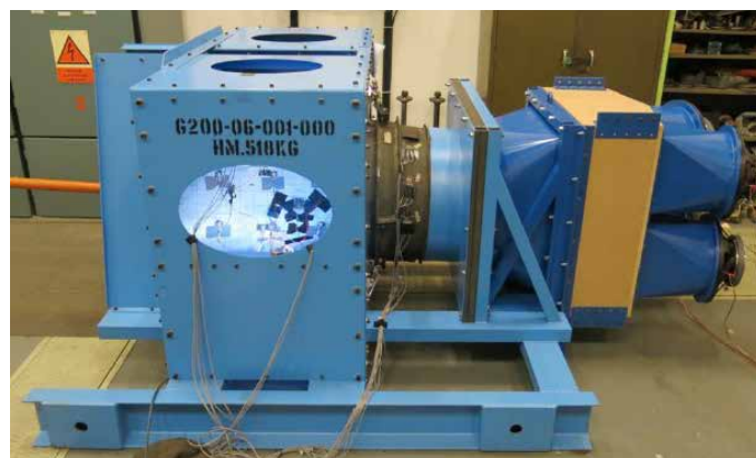
Obrázek 5 - Zkušební zařízení pro simulaci akustické zátěže
