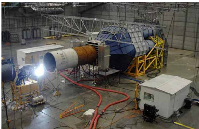
Obrázek 2 - Zkoušky tvorby námrazy na turbovrtulové jednotce, převzato z [1], McKinley Climatic Laboratory at Eglin Air Force Base, Florida
