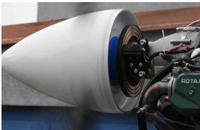
Obrázek 16 - Přenos energie do vrtule probíhá pomocí kontaktních kroužků
