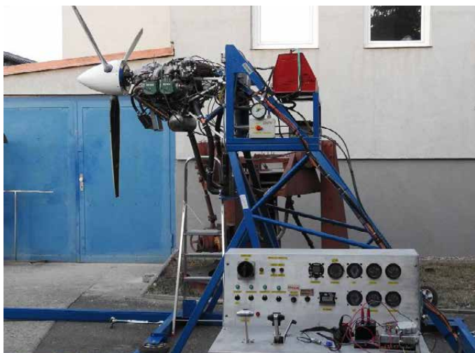
Obrázek 15 - Motorový stend s prototypem vrtule WOODCOMP KW-3x připravený ke zkouškám vzniku a odstranění námrazy
