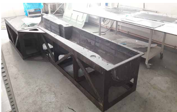
Obrázek 8 - Výroba kompozitní formy
