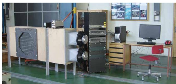
Obrázek 2 - Celkový pohled na zkušební zařízení pro zkoušky akustické únavy kompozitních panelů
