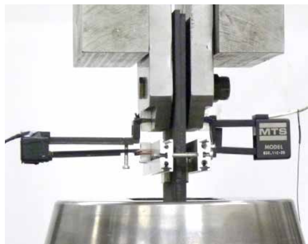
Obrázek 4 - Sestava zkoušky pro bearing test
