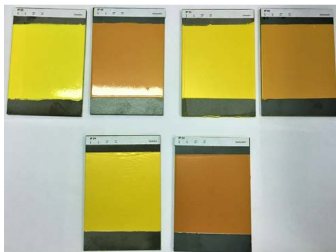
Obrázek 2 - Výsledné formulace. Zleva nahoře: IP02, IP 03 a dole IP 04, vlevo po ohřátí na teplotu přechodu.
