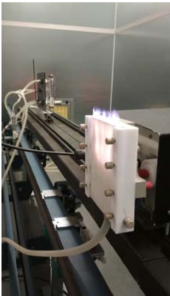
Detail promývačky s vodou/s aminem, přívodu plynů, plazmové trysky s přizpůsobovacím členem a generátorem
