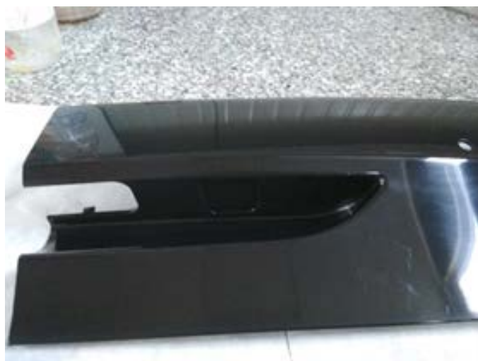
Materiál ABS – polovina spojleru
