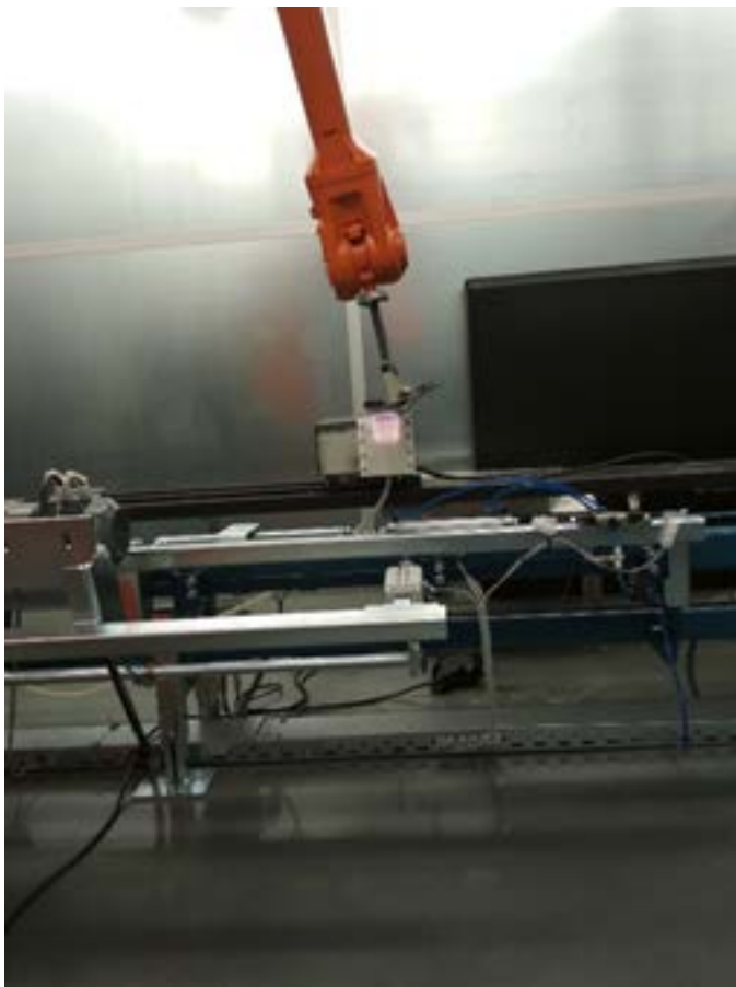
Robotická aplikace plazmatu na díl ABS - spojler
