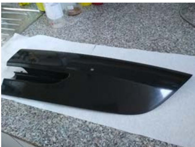
Materiál ABS – polovina spojleru
