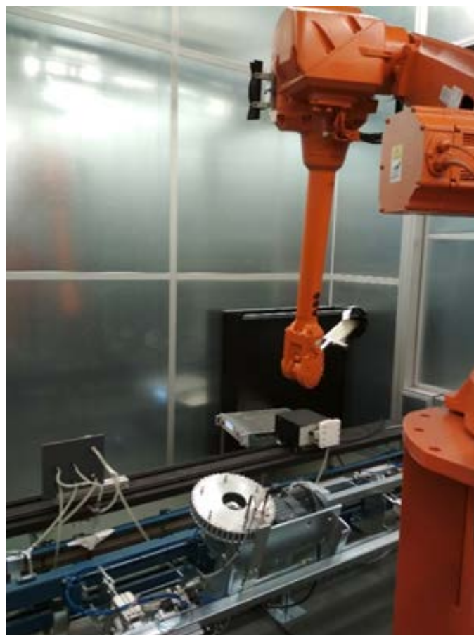
Celkový pohled na zařízení pro zkoušky robotické aplikace plasmatu
