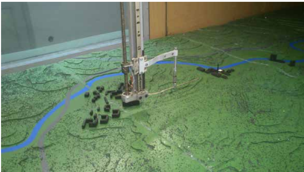
Obr. 1 Střední část terénního modelu s traverzovacím zařízením
