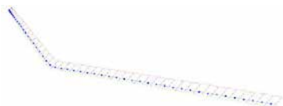
Obr. 3: tvar křídla s ohnutým wingletem a rozdělením na segmenty
