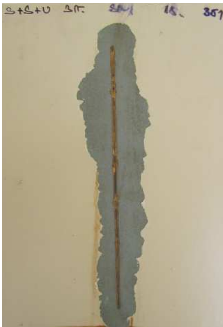
Obr. 4 Vzorek s nejlepší ochranou vůbec a vynikajícími 720 hod. solná mlha (nátěrový systém pro armádní účely); fyzikálně-mechanickými vlastnostmi
