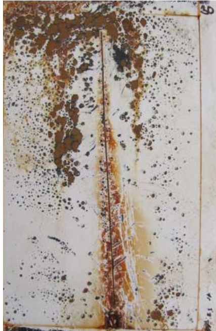
Obr. 2 a 3 puchýře 2vrstvých vodou ředitelných nátěrových systémů po expozici 150 hodin v solné mlze
