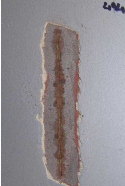
Obr. 1 Vzorek s umělým defektem po expozici 720 hodin v solné mlze, 3 vrstvý NS, 2x epoxid+ 1x akrylát;
