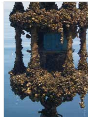
Obr. 2 VLEVO Detail přisedlých svijonožců, VPRAVO Zařízení masivně zanesené slávičkou Převzato z [2] a [3]
