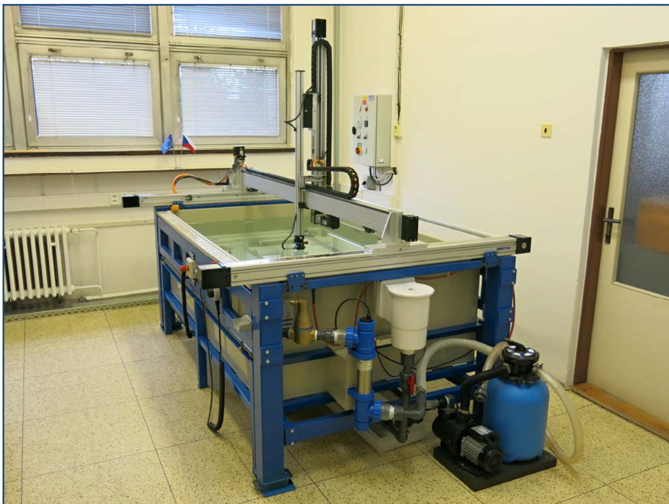
Obr.2 – Automatizovaný systém pro imerzní zkoušení instalovaný ve VZLÚ, a.s. na útvaru PK3200
