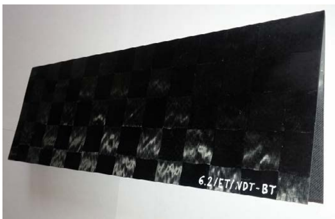
Obrázek 5 Nahoře etalon spoje pásnice hlavního nosníku a potahu, dole etalon spoje odtokové hrany.
