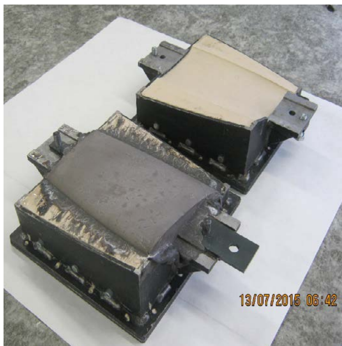
Obrázek 2 Lopatka - konstrukční varianta B (těsně po odformování)
