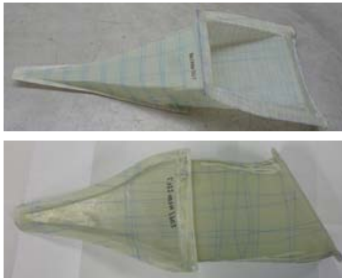
Obrázek 14 Kompozitní kanály vyrobené ve VZLÚ pomocí systému Aquapour™, Aquafill™, Aquaseal™
