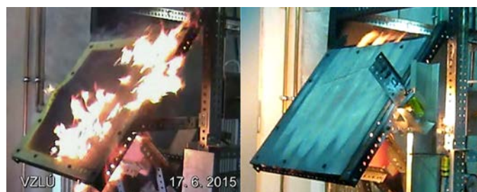
Obrázek 8 Zkouška prohoření dle ISO 2685. Vlevo panel sklo/fenol v 1. minutě zkoušky. Vpravo integrovaný panel uhlík/geopolymer L30 v 15. minutě zkoušky (zkušební útvar Motory VZLÚ, 116 kW/m 2 , 1 100°C, palivo JET A1). Geopolymerní panel přešel zkoušku bez zjevného poškození a při zachování původní integrované soudržnosti.
