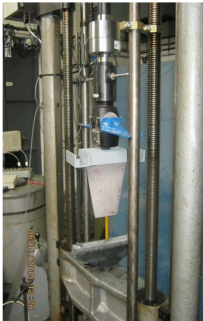
Obrázek 3 Statická zkouška simulující odstředivé zatížení lopatky
