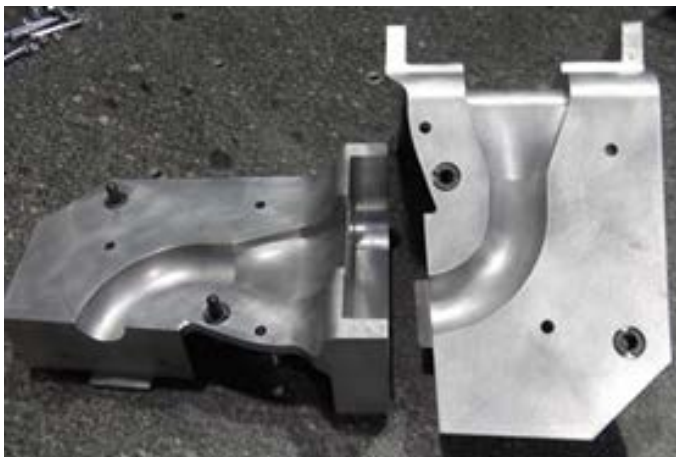
Obrázek 12 Forma pro odlévání solných jader [2]
