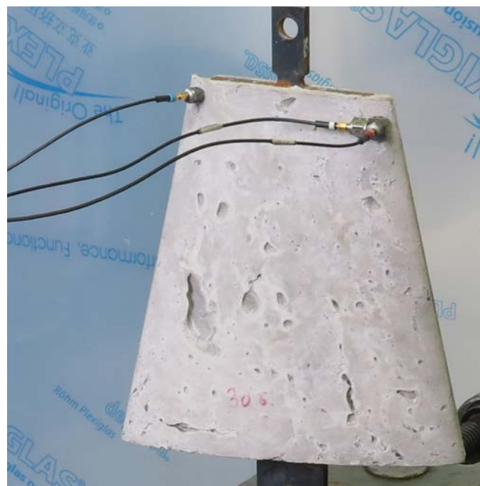
Obrázek 4 Modální zkouška lopatky rázem
