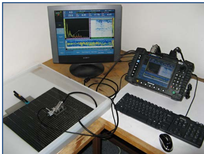
Obr.1 – Realizace kontaktního C-skeny kompozitního panelu v improvizované imerzní nádrži
