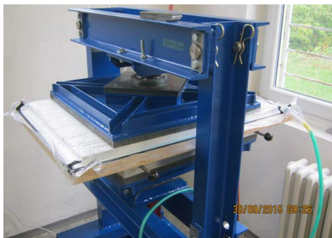
Obrázek 5 Vytvrzení panelu bylo provedeno ve vakuové obálce za současného působení tlaku v hydraulickém lisu
