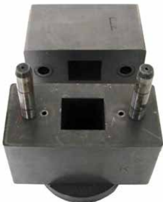
Obr. 3 Přípravek IITRI – ASTM D 3410
