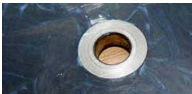
Obrázek 13. Implementace kovové vložky v kompozitu
