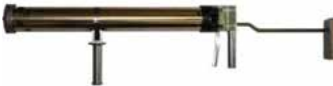
Obr. 31 Ruční impaktor VZLÚ
