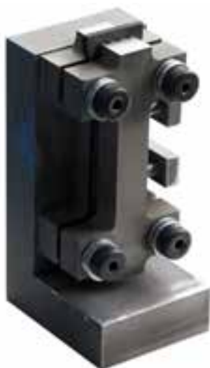
Obr. 2 Přípravek – ASTM D 695
