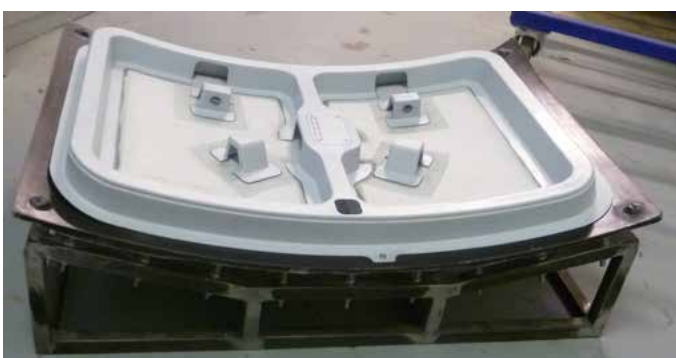
Obr. 8 – Lepící přípravek pro Nouzové pilotní dveře
