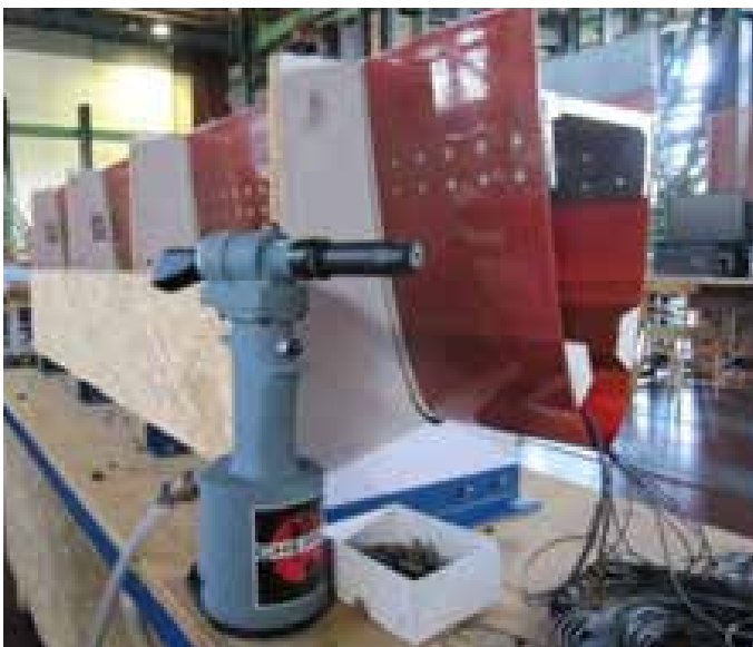
Obr. 8 Montáž náběžky v přípravku
