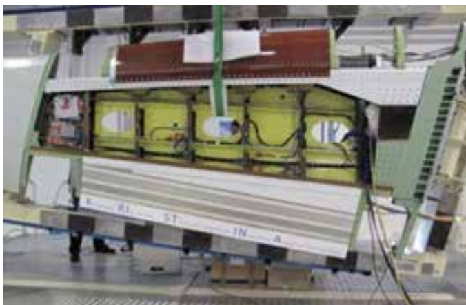
Obr. 14 Montáž náběžné hrany do zkušebního křídla
