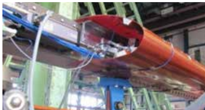
Obr. 18 Detail max. sklopení náběžky u kořene
