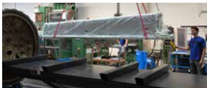
Obr. 2 Výroba polotovaru náběžky
