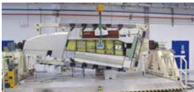
Obr.28 Namontovaný winglet ve zkušebním kusu křídla
