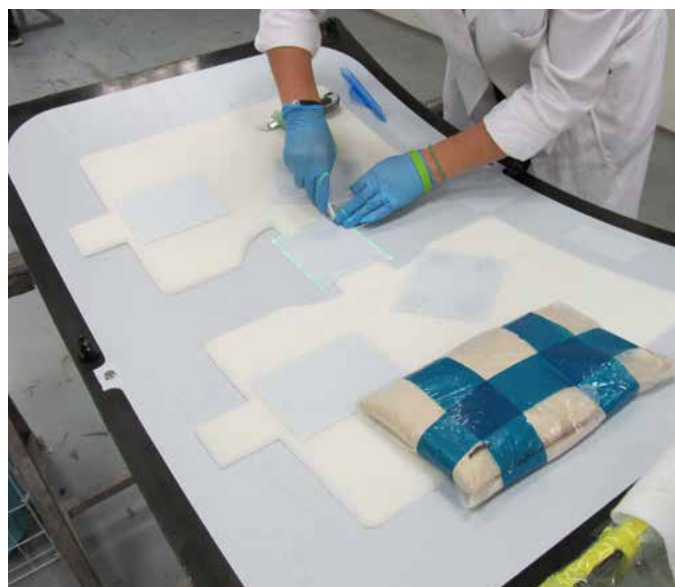
Obr. 10 – Skladba skořepiny dveří s použitím laserových projektorů
