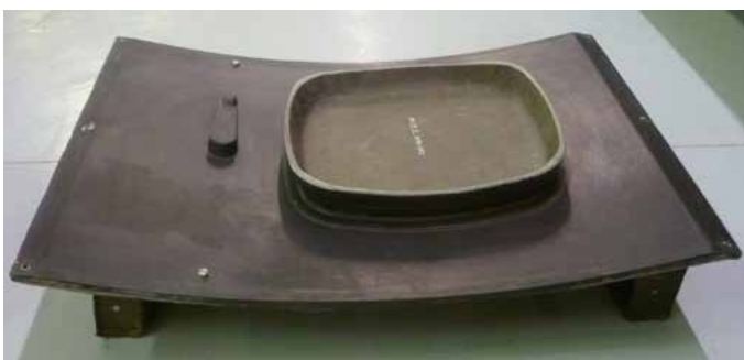
Obr. 7 - Dvoudílná forma vnější skořepiny nouzových dveří
