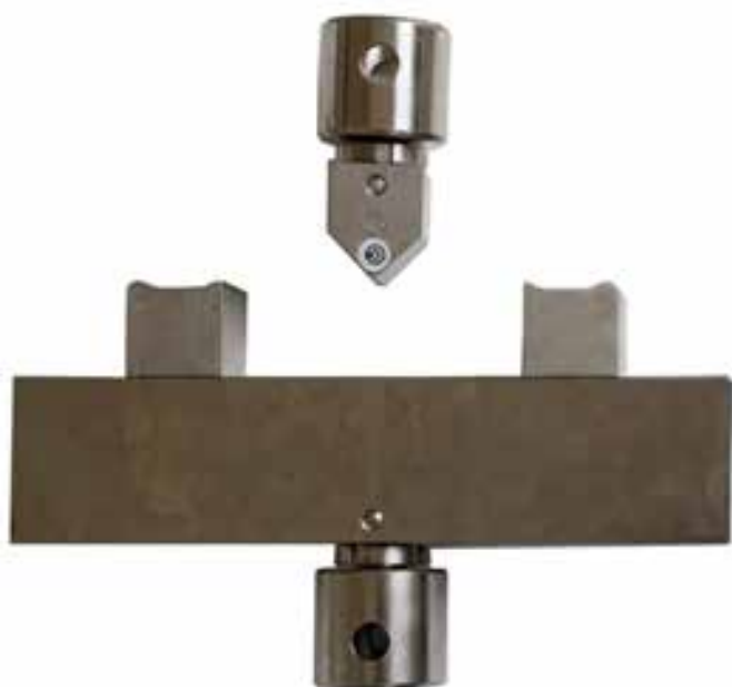
Obr. 5 Přípravek třibodový ohyb
