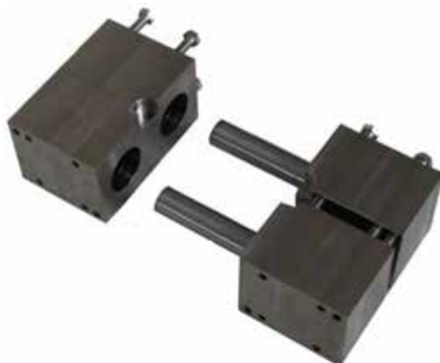
Obr. 4 Přípravek CLC - ASTM D 6641
