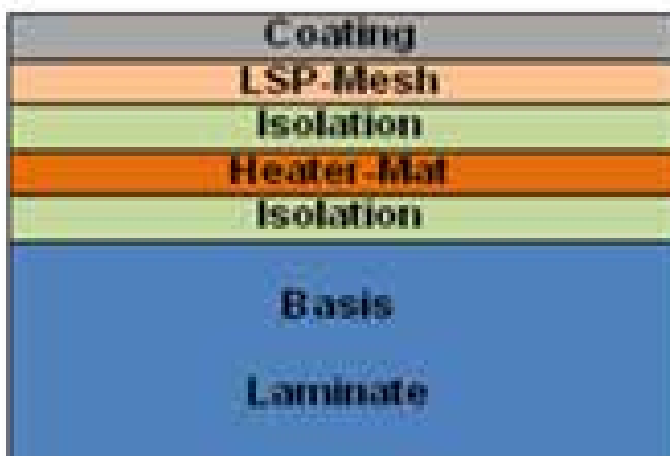
Obr. 4 Složení vrchních vrstev potahu náběžky
