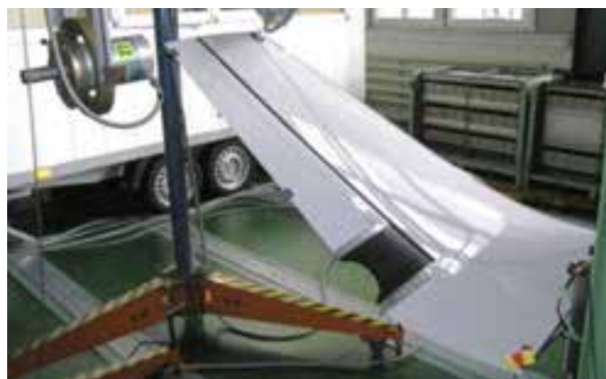
Obr. 24 Winglet při pozemní rezonanční zkoušce
