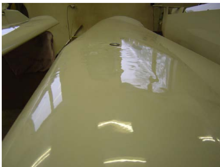
Obr. 13 Vady povrchu sendviče po průniku benzínu
