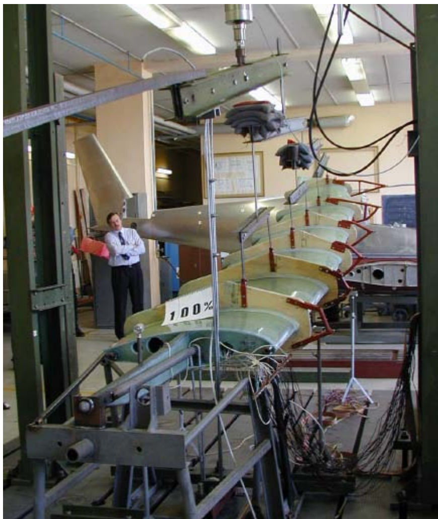
Obr. 4 Zátěžová zkouška křídla UFM-13 VUT Brno
