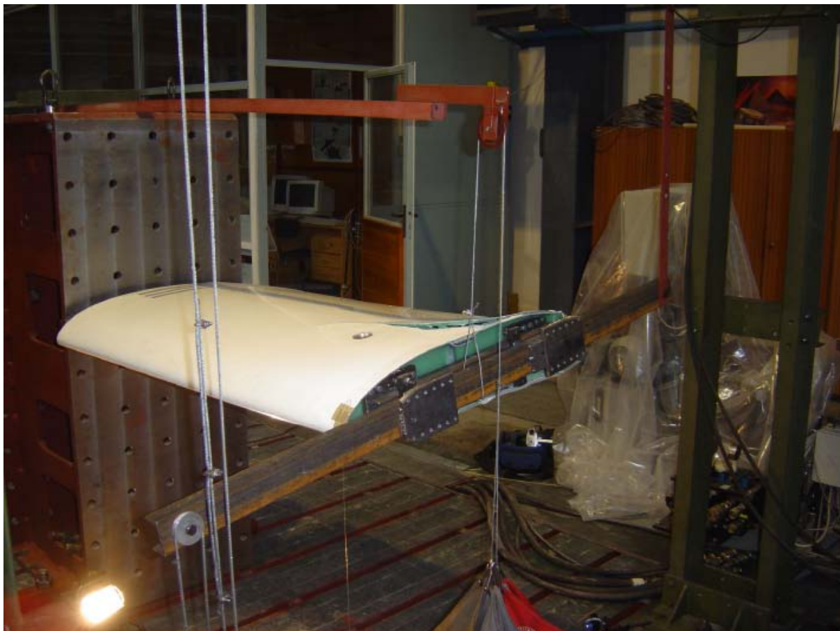
Obr. 9 Zkouška torsní dutiny křídla
