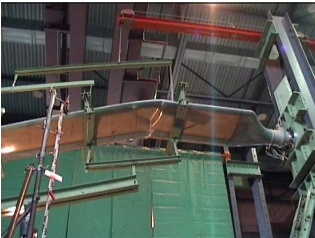
Obr. 3 Následné dolomení zkušebního tělesa.
