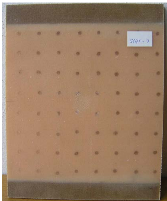
Obr. 1 Zesílení hran tvrzenou tkaninou Obr. 2 Zesílení hran vylitím pryskyřicí
