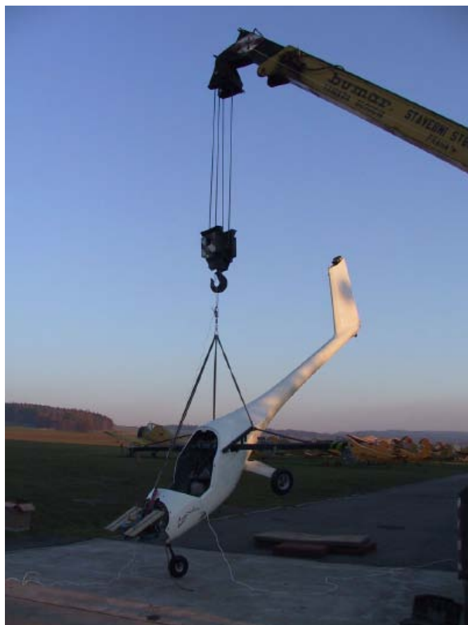
Obr. 12 Zkouška letounu UFM-13, dopadový úhel 45 °
