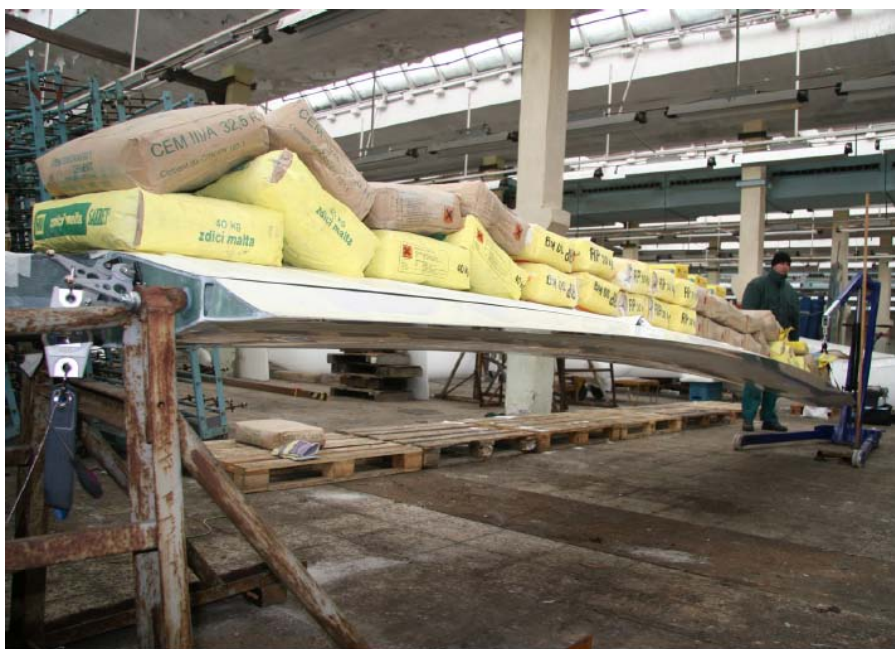
Obr. 15 Deformační zkouška systému flaperon křídlo
