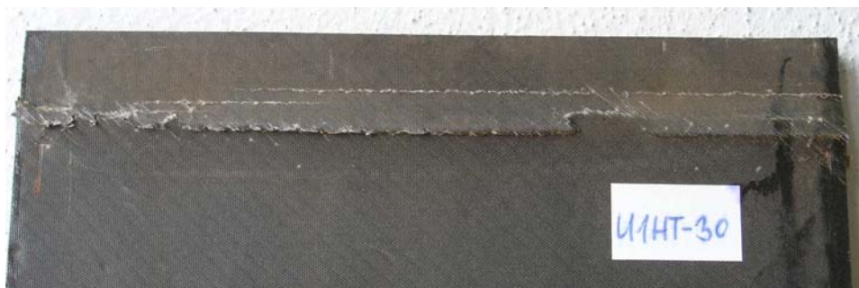
Obr. 18 Únavové porušení mimo regulární oblast
