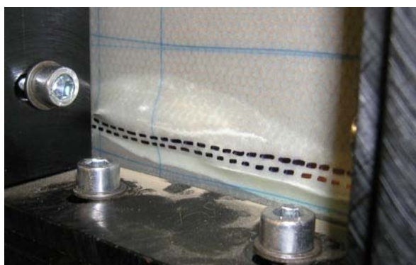
Obr. 14 Porušení vzorku u zesílené hrany
