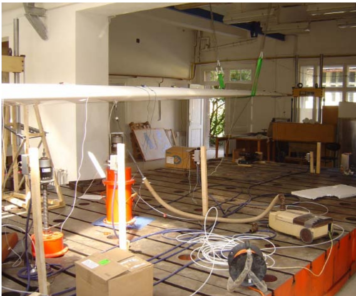
Obr. 7 Frekvenční zkoušky křídla
