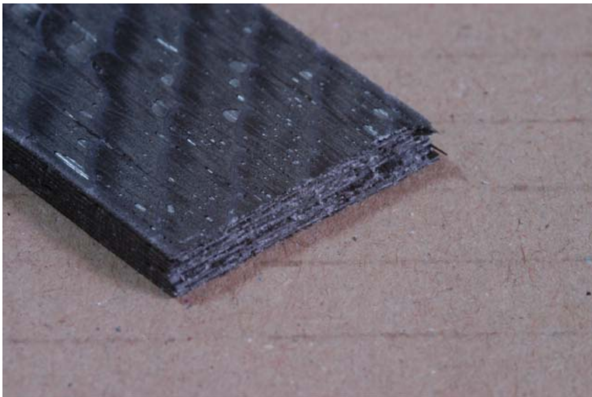
Obr. 16 Porucha srovnávacího vzorku uhlíkové tkaniny
