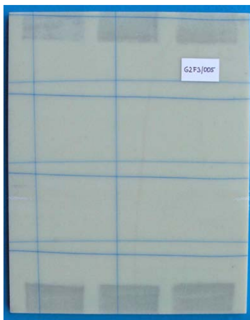
Obr. 1 Zesílení hran tvrzenou tkaninou Obr. 2 Zesílení hran vylitím pryskyřicí
