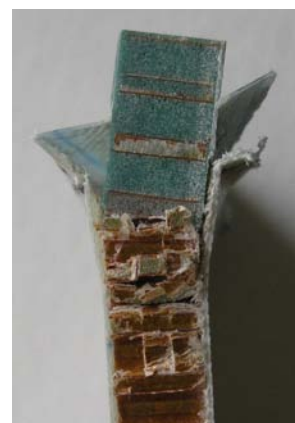
Obr. 16 a obr. 17 Únavové porušení mimo regulární oblast
