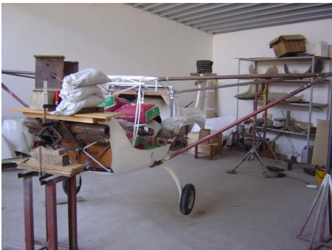
Obr. 2 Zkouška trupu JORA
