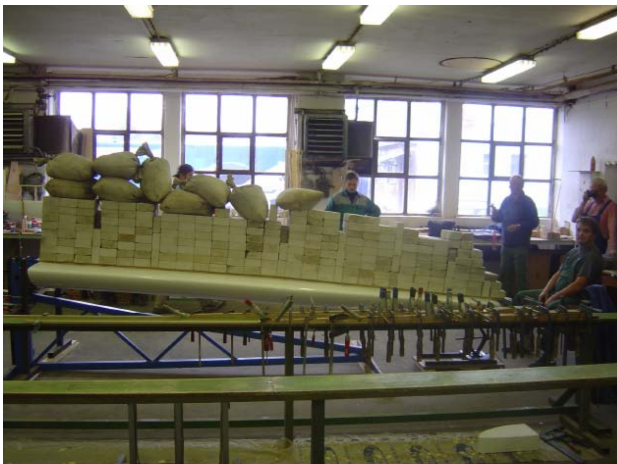
Obr. 3 Zátěžová zkouška křídla letounu Faeta
