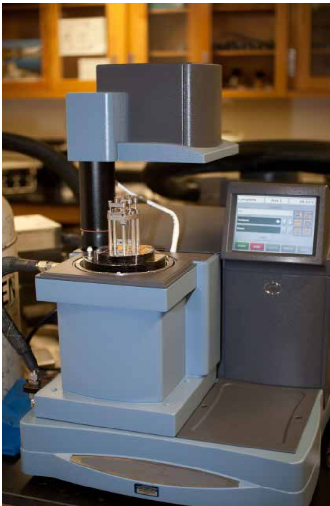
Obr. 8 Dynamický mechanický analyzátor.
