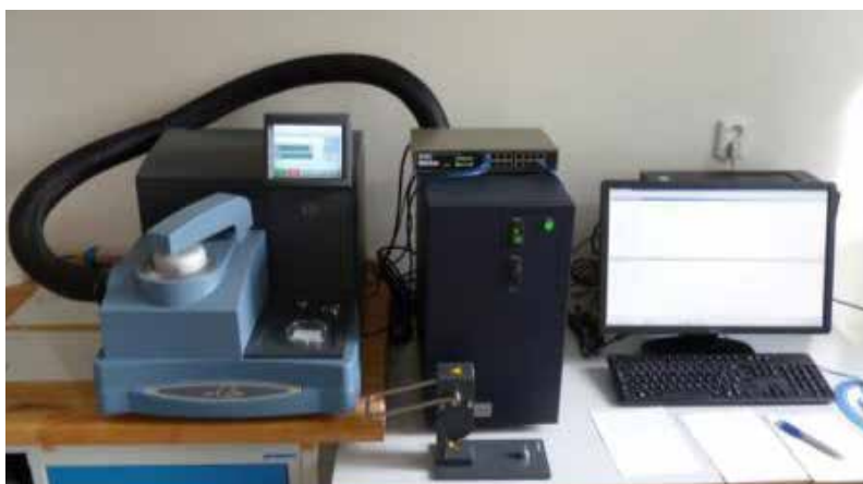
Obr. 4 Diferenční skenovací kalorimetr používaný ve VZLÚ.
