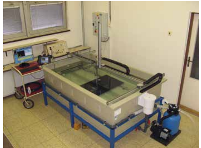
Obr.2 Ultrazvukový NDT systém pro imerzní zkoušení
