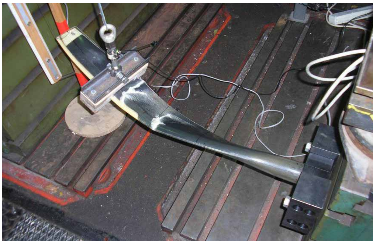
Statická zkouška celokompozitního vrtulového listu
