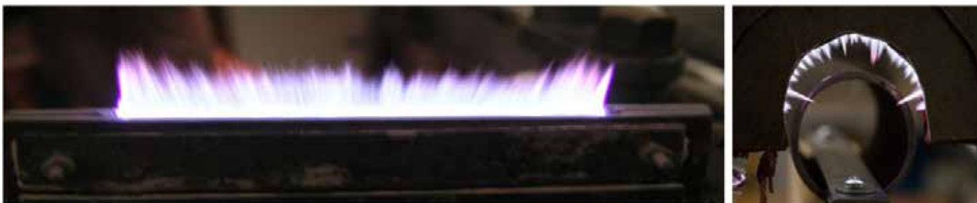
Obr. 3 Lineární zdroje plazmatu - radiofrekvenční štěrbinová plazmová tryska v rovinné geometrii (vlevo) a v geometrii pro povrchovou úpravu trubek (vpravo) – vyvinuty u nás na pracovišti a používají argon s různými příměsemi nebo prekurzory.
