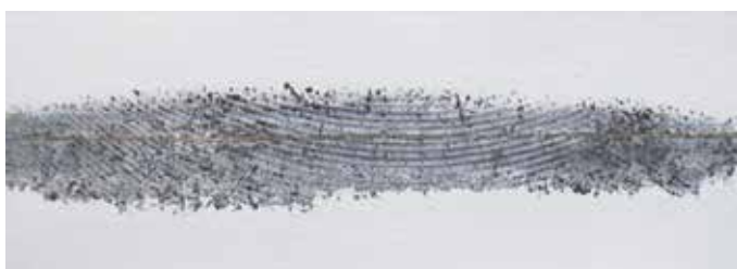
Obr. 4 Koroze podél řezu na vzorku opatřeném systémem I6 po cyklické zkoušce vlhkým teplem
