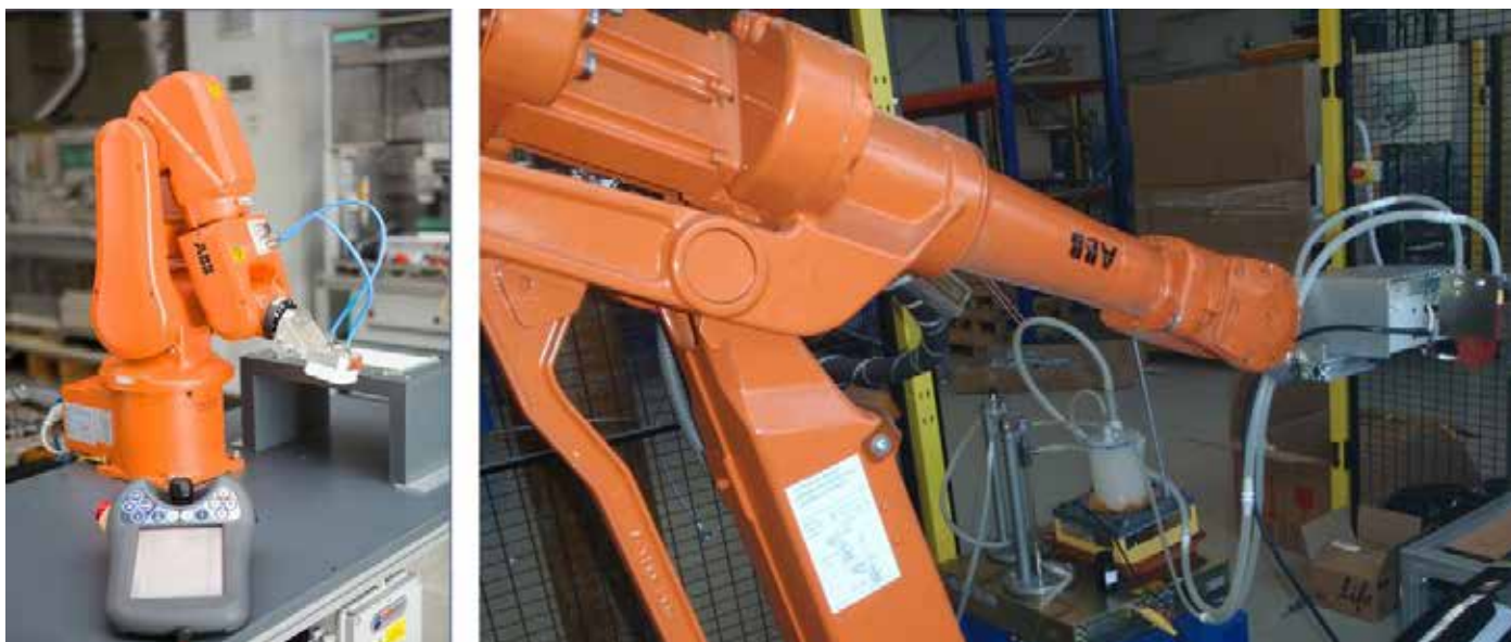
Obr. 8 a obr. 9 Příklad upevnění koplanárního plazmového zdroje k robotickému ramenu pro předúpravy povrchů (vlevo) a testování robotické aplikace štěrbinových plazmových trysek s aerosolovými prekurzory (vpravo).
