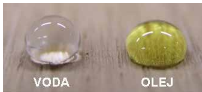
Obr. 12 Příklad ultrahydrofobního a současně superoleofobního povrchu vytvořeného na dřevě
