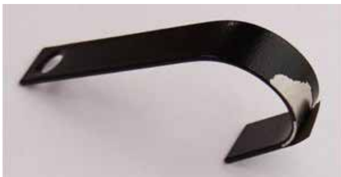
Obr. 7 Porovnání zvýšení adheze nanesené barvy BLACK BIG TRUCK k povrchu ocelových pásků (3-vrstvý systém - 1x základní nátěr + 2x finální nátěr), které byly modifikovány plazmatem ve fázi před druhým finálním nátěrem (vpravo), oproti vzorku bez plazmové úpravy (vlevo) (ohybový test) [2].
