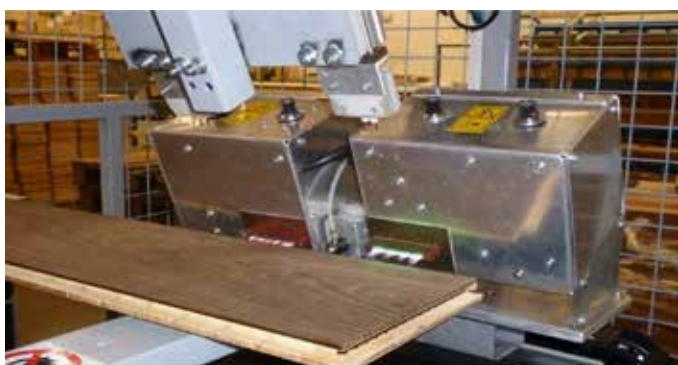
Obr. 10 Příklad realizované technologie štěrbinových plazmových trysek při výrobě dřevěných parket (lineární posuv trysek + točna 270o ).
