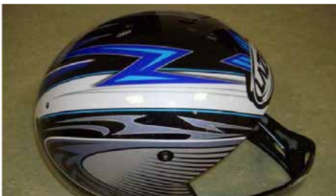
Obr.10 Plastový materiál, 2-fázový proces: Hydro-Base Coat + 100% UV-lak
