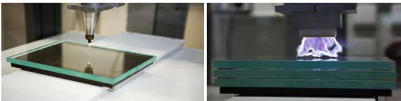
Obr. 1 Komerční plazmové trysky využívané v naší laboratoři (vzduch, N 2 ) - vyfoukávaný oblouk (vlevo), vyfoukávaný klouzavý výboj (vpravo).
