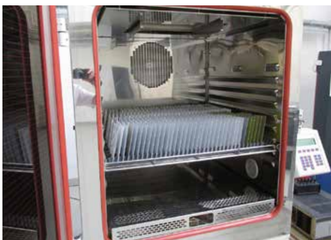
Obr. 3 Nátěrové systémy v klimatické komoře před zkouškou vlhkým teplem cyklickým
