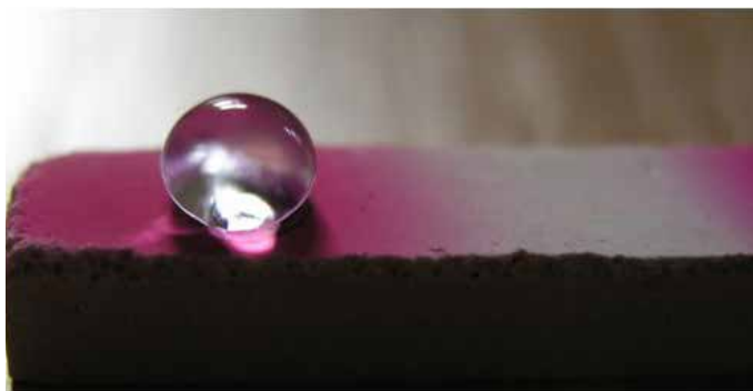
Obr. 11 Ultrahydrofobní ochranná povrchová úprava s možností barvitelnosti (pigmenty).
