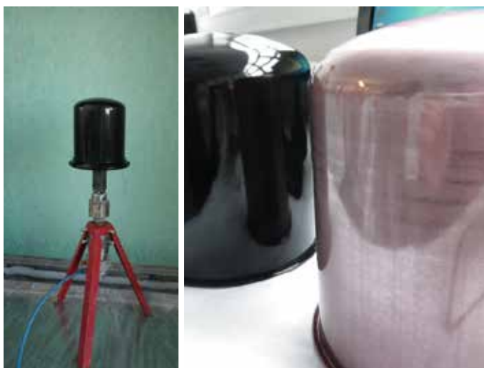
Obr. 13 Kovový materiál - olejové filtry (pozinkovaný plech), 1K 100%ní UV laky
