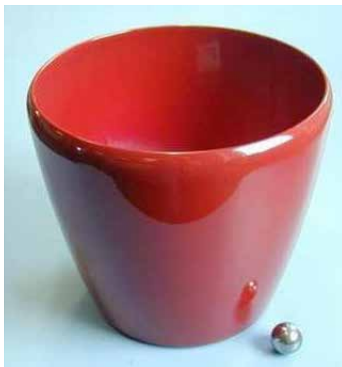
Obr. 12 Plastové materiály PP a ABS, 2-fázový proces: 2K-PUR-jednovrstvý lak na vodní bázi +2K-UV-jednovrstvý lak, 2-složkový Hydro Base Coat + 100% UV-Clear-Coat
