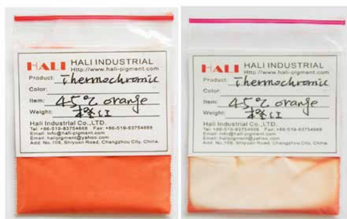
Obr. 5 Termochromický pigment před a po zahřátí [7]
