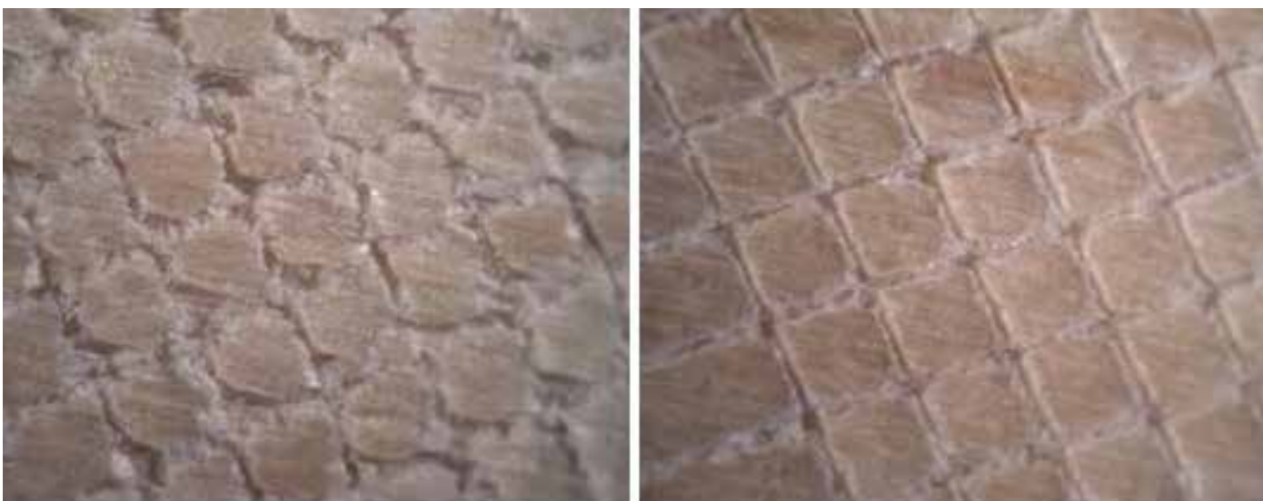
Obr. 5 Porovnání zvýšení adheze polyuretanového laku (PUR) k povrchu bukového dřeva, které bylo před lakováním předupraveno plazmatem (vpravo), oproti vzorku bez plazmové úpravy (vlevo) (zkouška mřížkovým řezem).
