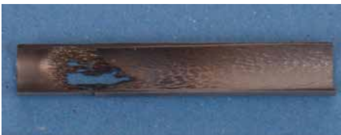
Obr. 15 Eroze stěny ejektoru při tkání skleněných přízí
