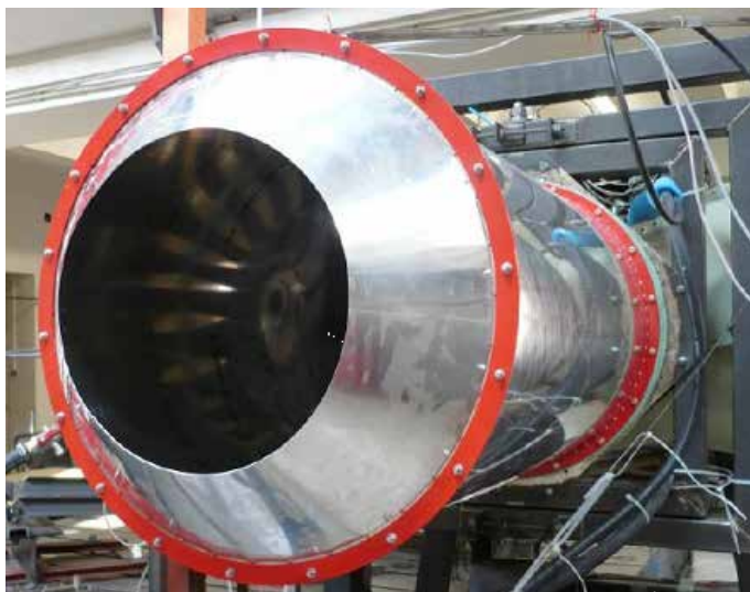
Obr. 15 Výměnná tryska používaná Ústavem letadlové techniky [5]
