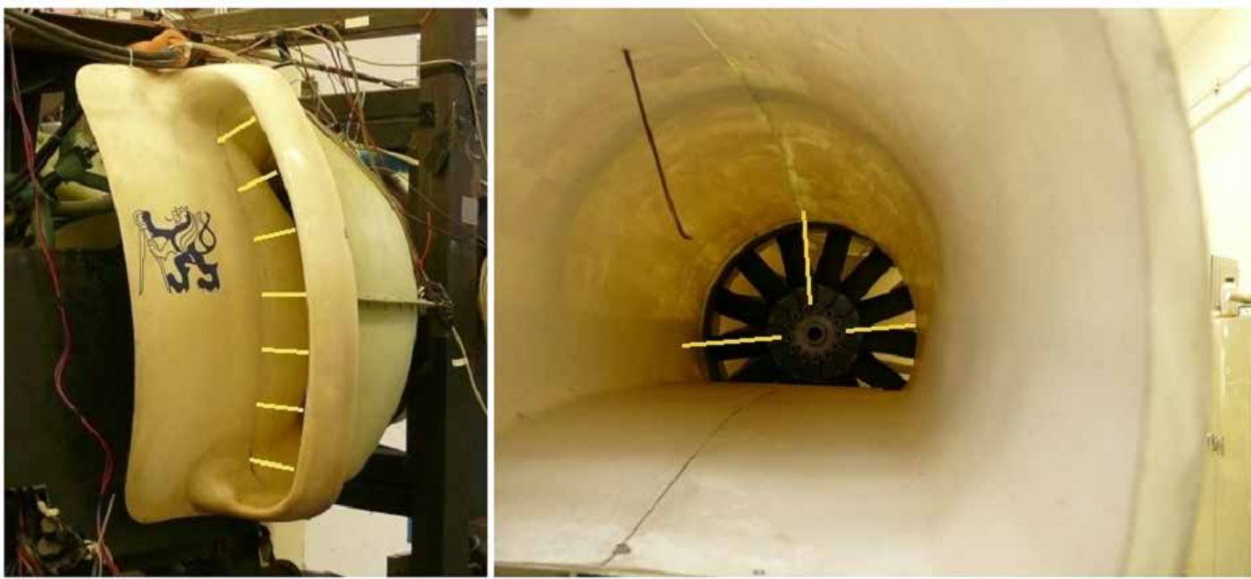
Obr. 13 Rozmístění sond v měřících rovinách. Vlevo vstupní průřez, vpravo rovina za rotorem.
