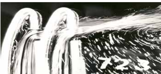
Obr. 18 Průtok štafetovou tryskou - hydraulická analogie
