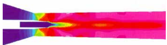
Obr. 12 Izočáry Machova čísla v divergentním směšovací ejektoru
