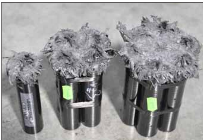
Obr. 1 - Zkušební deformační členy z navíjených kompozitních prvků (základní trubka, svazek 4 a svazek 7 trubek)
