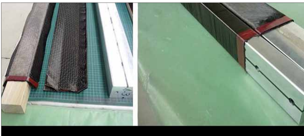
Obr. 10 - Výroba preformů nosníku tvaru C (vlevo) a tvaru JF (vpravo) s využitím UD-pletení [1]
