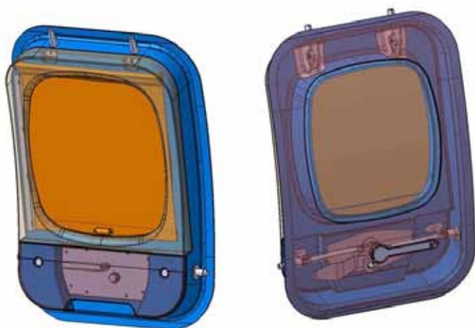
Obr. 1 - Konstruktivní řešení kompozitových nouzových dveří v kabině cestujících
