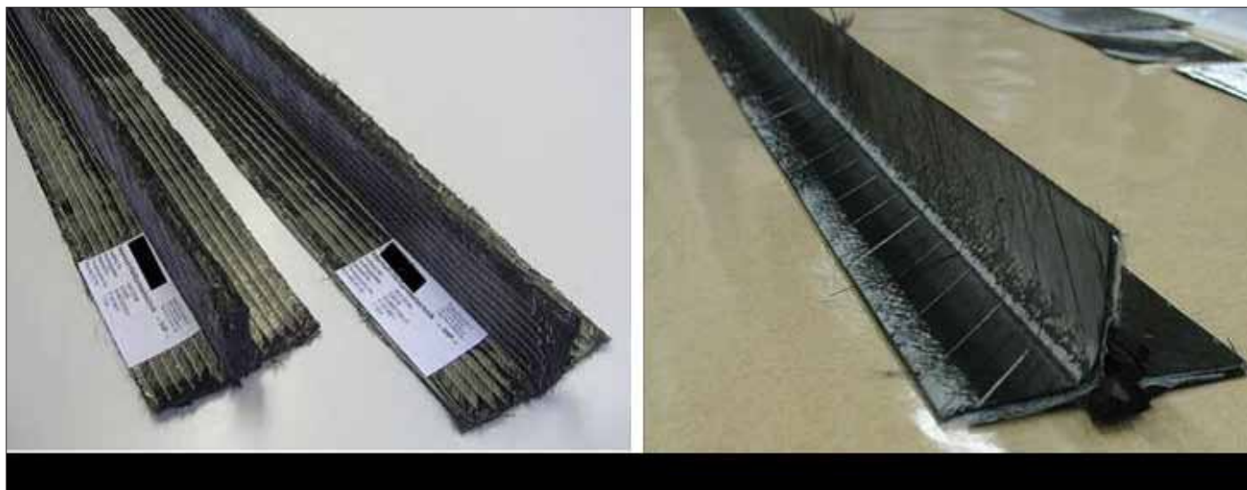
Obr. 8 - Preformy podélníků vyrobené HP (vlevo) a FPP (vpravo) technologií [1]
