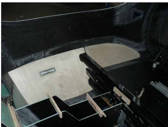
Obr. 12 - Vnitřní konstrukce trupu v prostoru kabiny před přelaminováním bočních žebér zachycujících síly od hlavního podvozku
