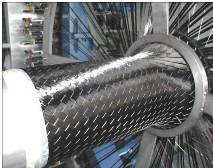
Obr. 1 - UD-opletení jádra (mandrel)
