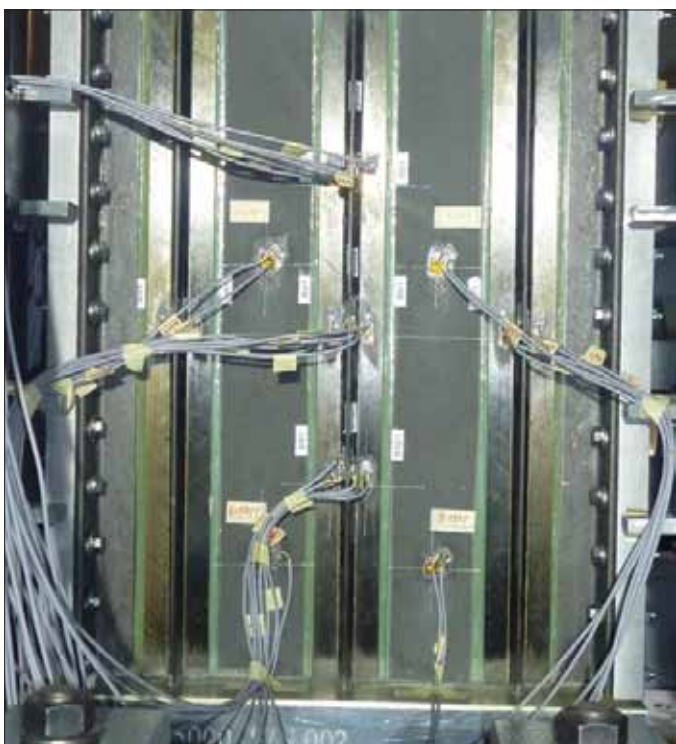
Obr. 4 - Zakřivený trupový panel s T-podélníky vyrobenými FPP technologií
