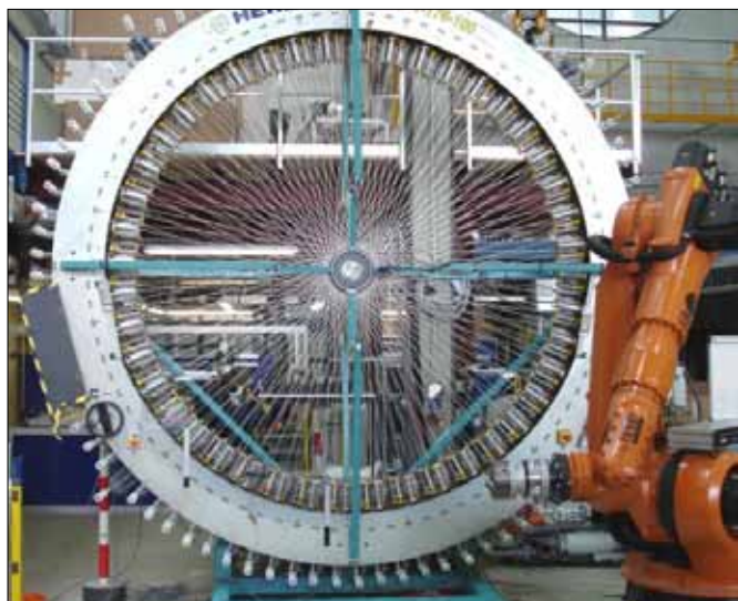
Obr. 2 - Radiální "braider" (vlevo) a opletené jádro (mandrel) (vpravo) [7], [8].
