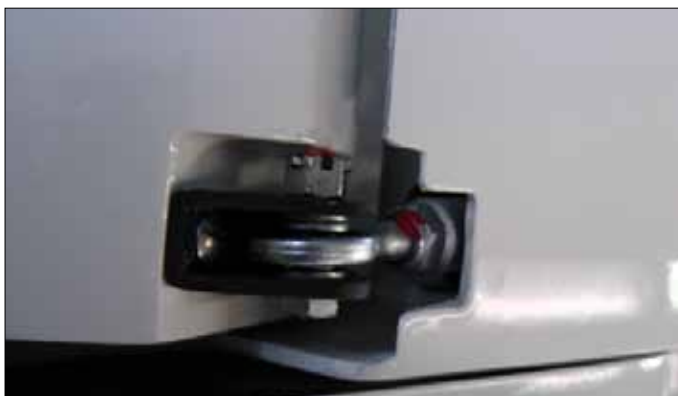
Obr. 6 - Ovládací uhlíkový závěs křídélka
