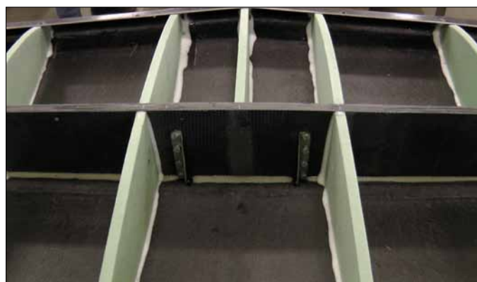
Obr. 11 - Konstrukce VOP před zavřením horního potahu
