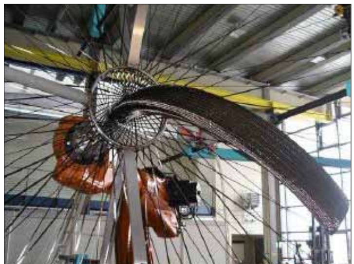
Obr. 2 - Radiální "braider" (vlevo) a opletené jádro (mandrel) (vpravo) [7], [8].
