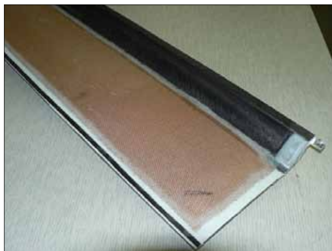
Obr. 5 - Nalaminovaný sendvič s nomexovou voštinou křídélka
