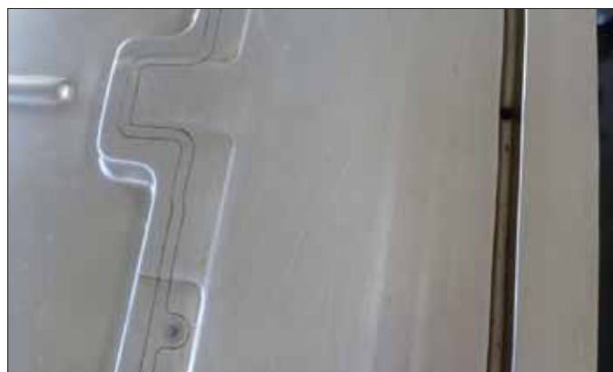
Obr. 1 - Forma vyrobená s drážkou pro použití permanentní plachetky
