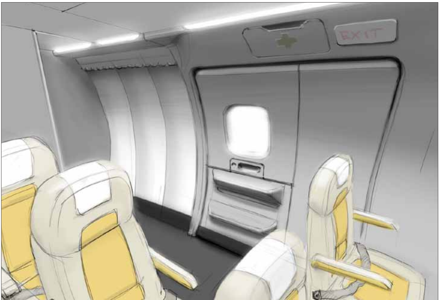
Obr. 5 - Řešení vnitřní plochy vstupních a nákladových dveří spolu s interiérovými panely
