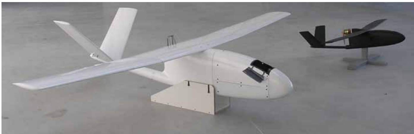
Bezpilotní letoun vyvíjený VTÚL ve spolupráci s VZLÚ a jeho tunelový model
