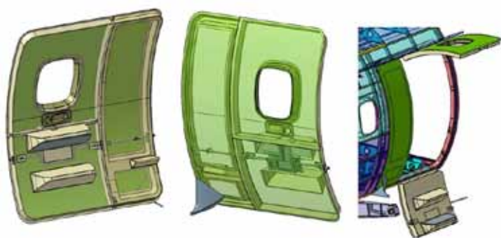
Obr. 3 - Konstruktivní řešení kompozitových vstupních a nákladových dveří
