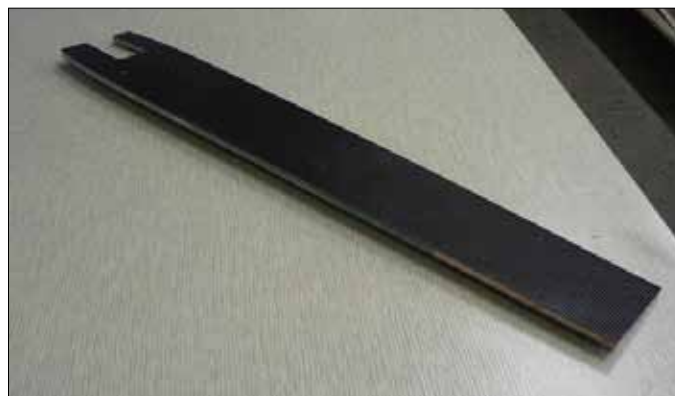
Obr. 9 - Steven vyrobený z uhlíkového kompozitu a herexu
