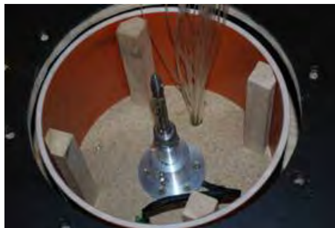
Obr. 2 - Tenzometrická váha pod modelovým prostorem BLWT
