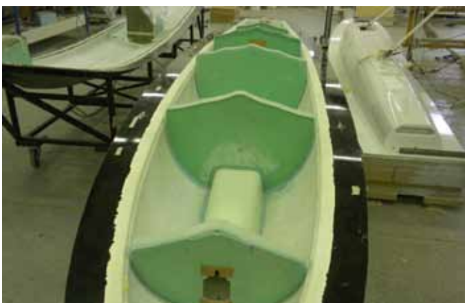
Obr. M – Zalepená žebra a další malé díly do horního potahu plováku
