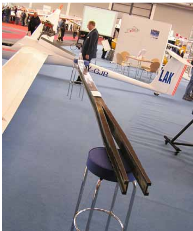
Obr. 6 Kompozitový nosník křídla větroně LAK 25
