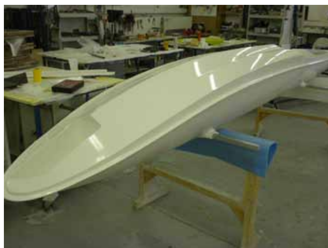
Obr. P – Ořezávání dle předznačených kontur a hotové těleso plováku
