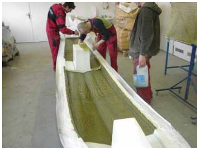
Obr. H – Nanášení povrchové vrstvy a manuální laminace ve formě
