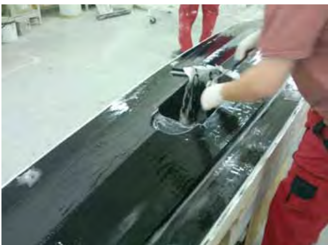
Obr. E – Výroba sklolaminátové skořepiny formy
