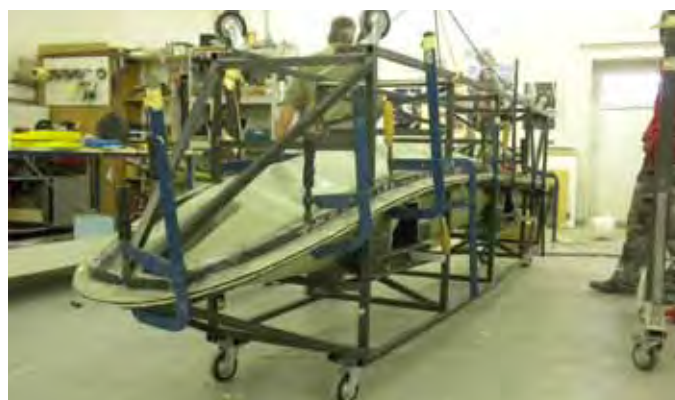
Obr. N – Uzavírání tělesa plováku slepením potahů
