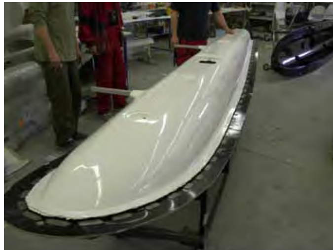
Obr. O – Vyjímání tělesa plováku z forem
