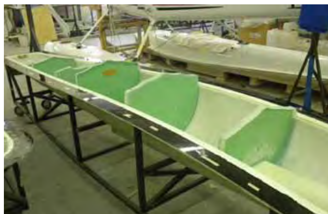
Obr. M – Zalepená žebra a další malé díly do horního potahu plováku
