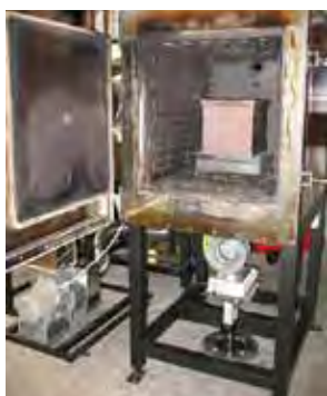
Obr. 1 Reakční komora laboratorního zařízení pro tepelný rozklad kompozitů
