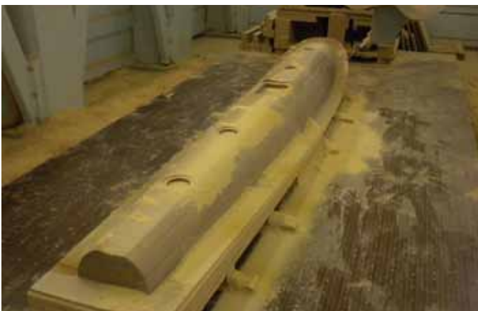
Obr. C – Obrábění načisto nasyceného povrchu modelu
