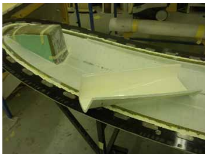
Obr. I – Instalace pěn sendviče a skladby vnitřního potahu sendviče
