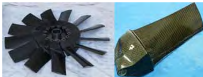
Obr. 4 Rotor pohonné jednotky vlevo, vpravo lopatka rotoru
