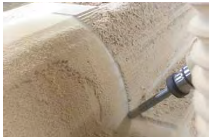
Obr. B – Obrábění horního modelu horního potahu plováku
