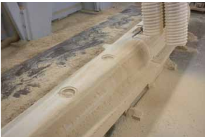
Obr. B – Obrábění horního modelu horního potahu plováku
