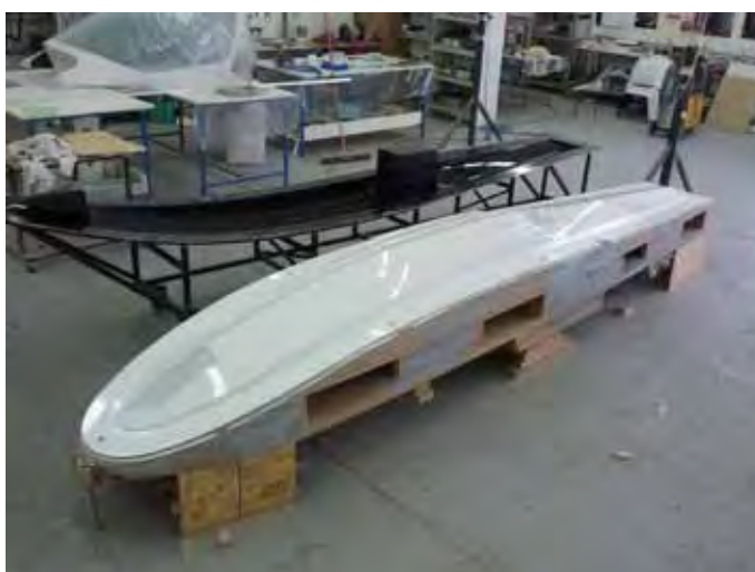
Obr. G – Odformovaný model a hotová negativní forma spodního potahu
