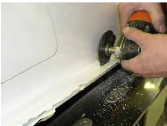
Obr. P – Ořezávání dle předznačených kontur a hotové těleso plováku
