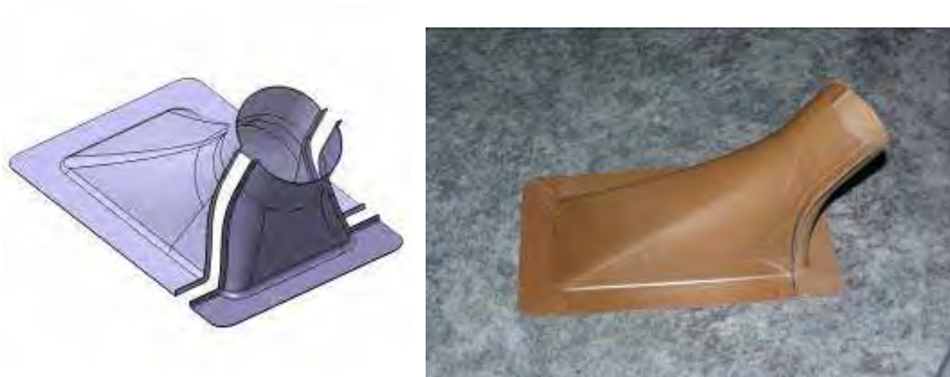
Obr. 8. Vzduchovod z materiálu C/PPS
