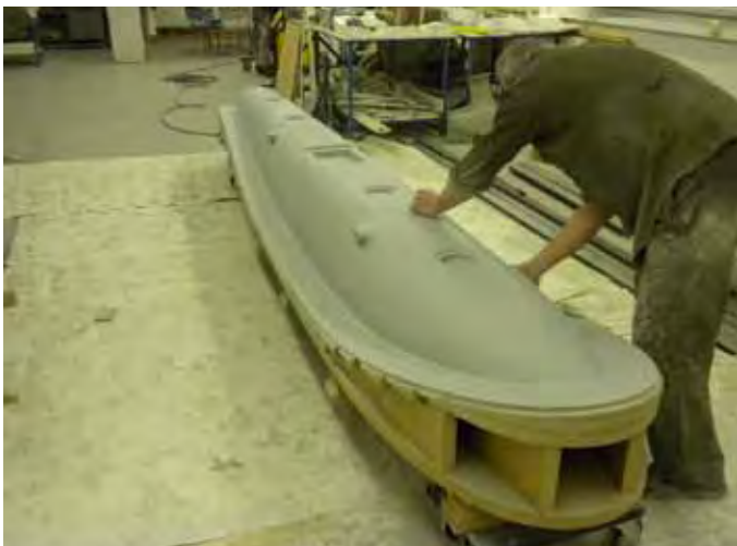
Obr. D – Úprava povrchu modelu nástřikem plnicího tmelu a barvou
