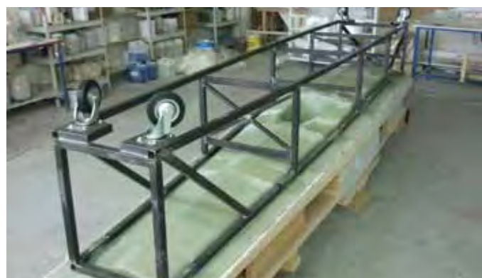
Obr. F – Výroba sklolaminátové skořepiny formy + ocelový rám s kolečky
