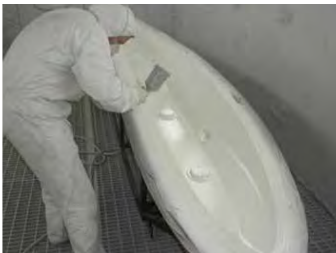
Obr. H – Nanášení povrchové vrstvy a manuální laminace ve formě
