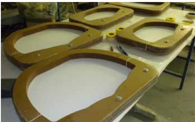
Obr. L – Formy pro výrobu žebel a hotové žebro tělesa plováku
