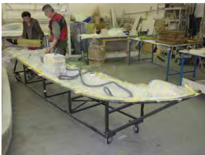
Obr. I – Instalace pěn sendviče a skladby vnitřního potahu sendviče
