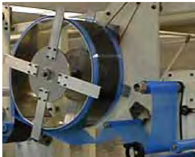
Obr. 12 Detail navedení prepregové pásky
