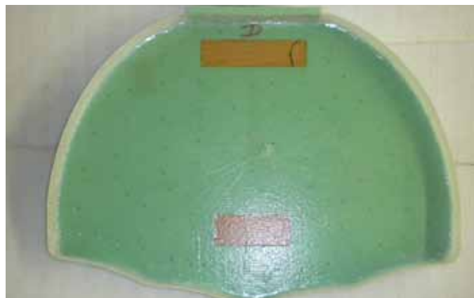
Obr. L – Formy pro výrobu žebel a hotové žebro tělesa plováku
