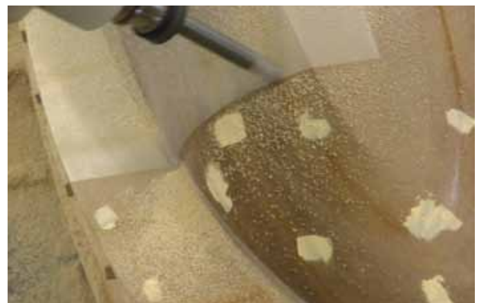
Obr. C – Obrábění načisto nasyceného povrchu modelu
