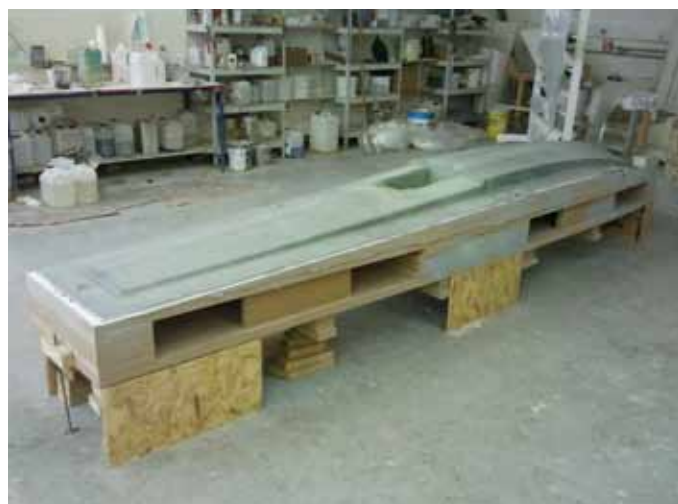
Obr. E – Výroba sklolaminátové skořepiny formy
