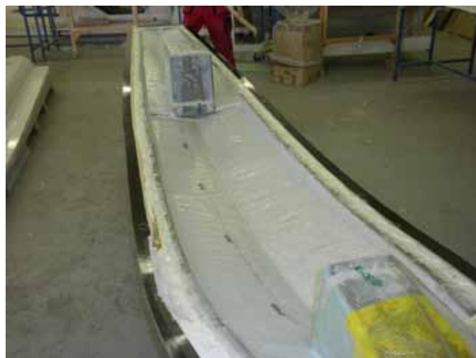
Obr. I – Instalace pěn sendviče a skladby vnitřního potahu sendviče
