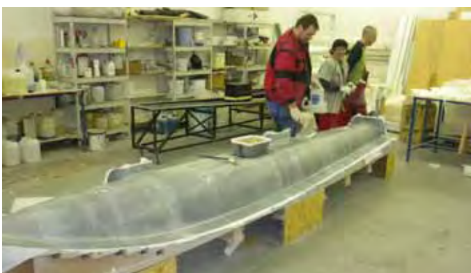
Obr. F – Výroba sklolaminátové skořepiny formy + ocelový rám s kolečky
