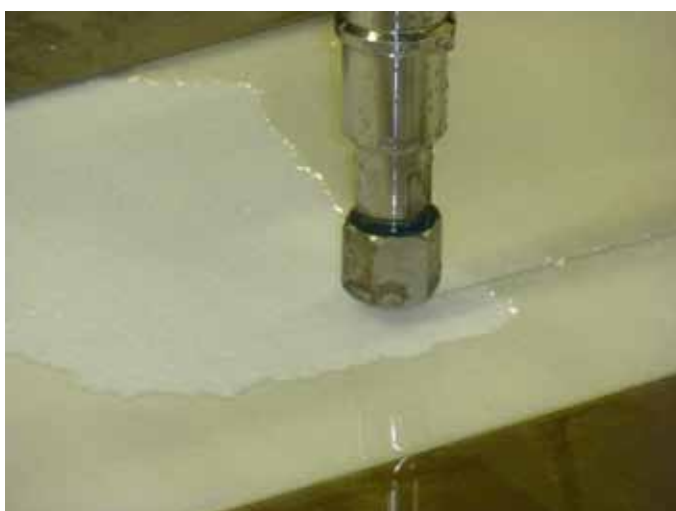
Obr. K – Vyřezávání tvarů pěn sendviče pomocí technologie vodního paprsku
