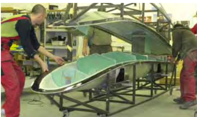
Obr. N – Uzavírání tělesa plováku slepením potahů
