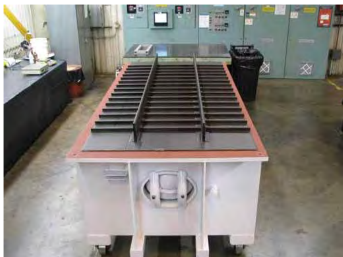
Obr. 18 Vyrobený demonstrátor - preform a pultruzní profily vyrobeny pomocí VARTM. Potvrzení dobrého provázání pultruzních profilů a potahu
