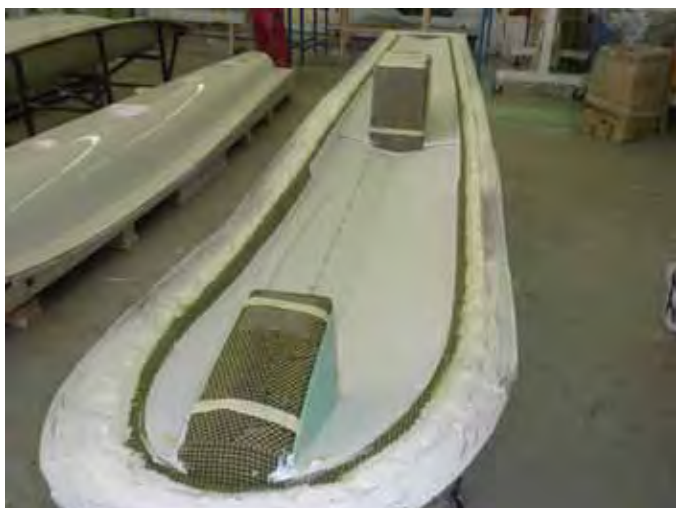
Obr. I – Instalace pěn sendviče a skladby vnitřního potahu sendviče
