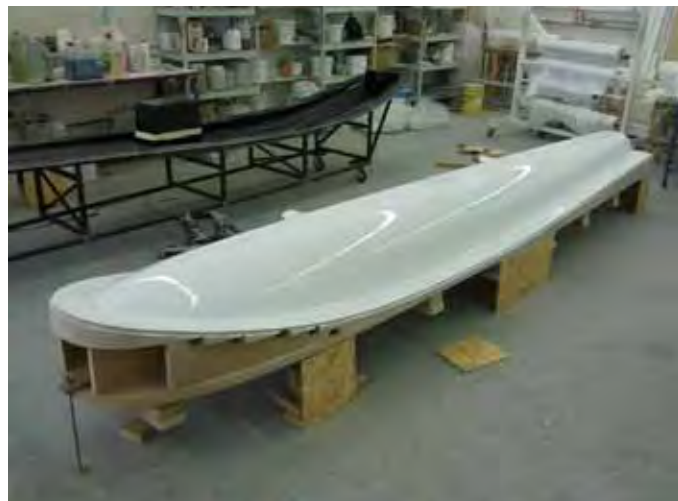
Obr. D – Úprava povrchu modelu nástřikem plnicího tmelu a barvou
