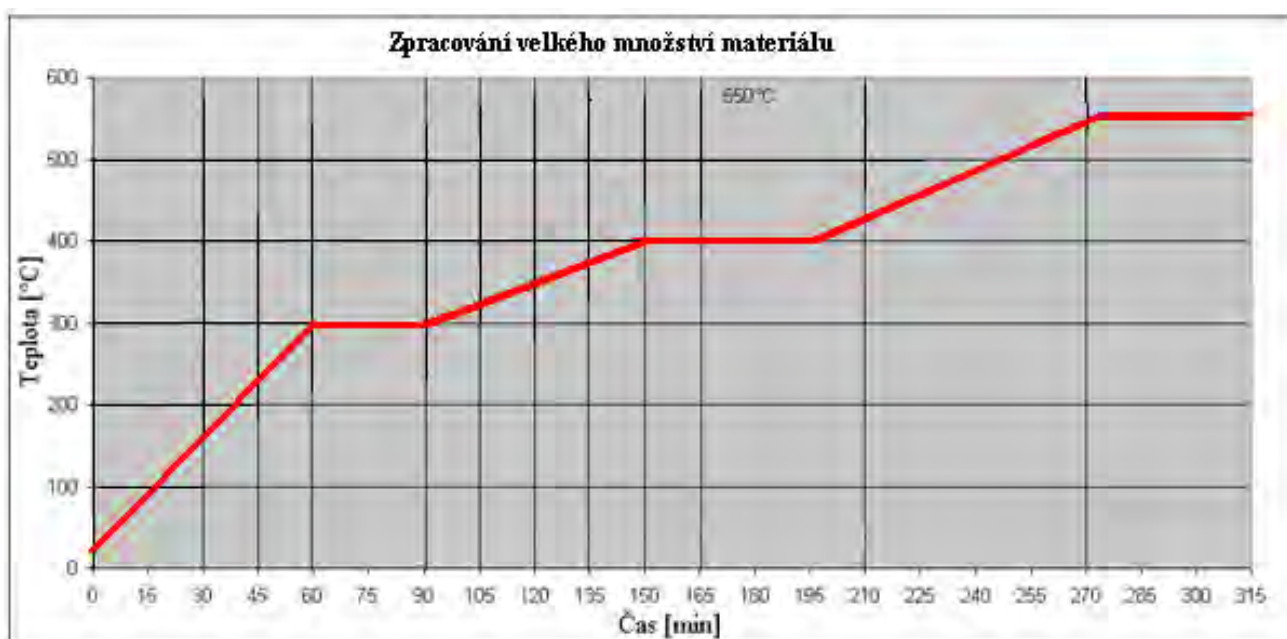
Obr. 2 Univerzální teplotní režim pro laboratorní recyklační zařízení ve VZLU, a.s., vsázka 1,5 - 2,5 kg. (Zpráva R4883 Recyklace kompozitního materiálu nižší homogenity, Cihelník K., VZLU 2010)
