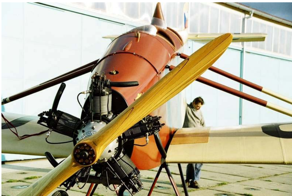
Obr. 9 Vrtule V238 v původním provedení instalovaná na replice letounu (foto M. Sezemský, HLRČS)
