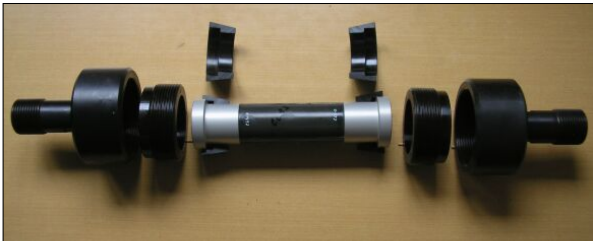
Obr. 16 Dvoukořen se systémem upínacích přípravků
