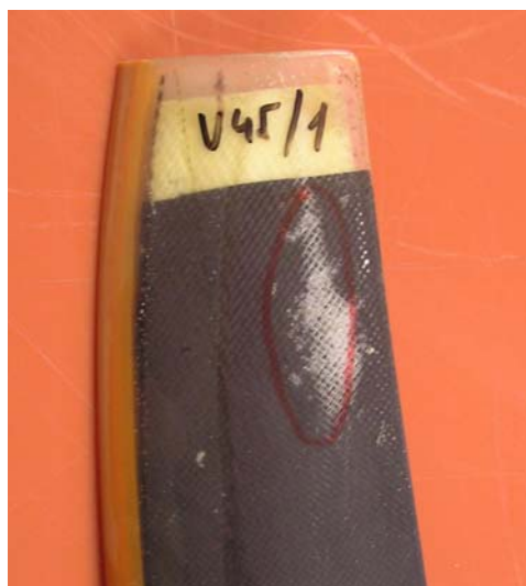
Obr. 11 Vada predikovaná v MKP se objevuje i na reálném kusu
