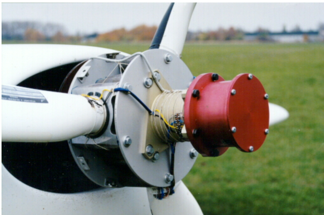
Obr. 6 Detail instalace přenosové aparatury na vrtulové hlavě
