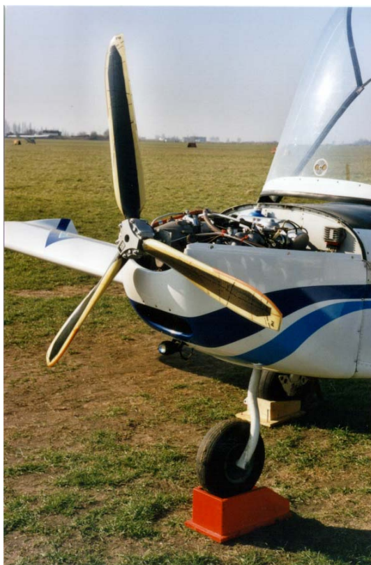
Obr. 2 Pozemní zkoušky prototypu kompozitní vrtule VZLÚ V36o.
