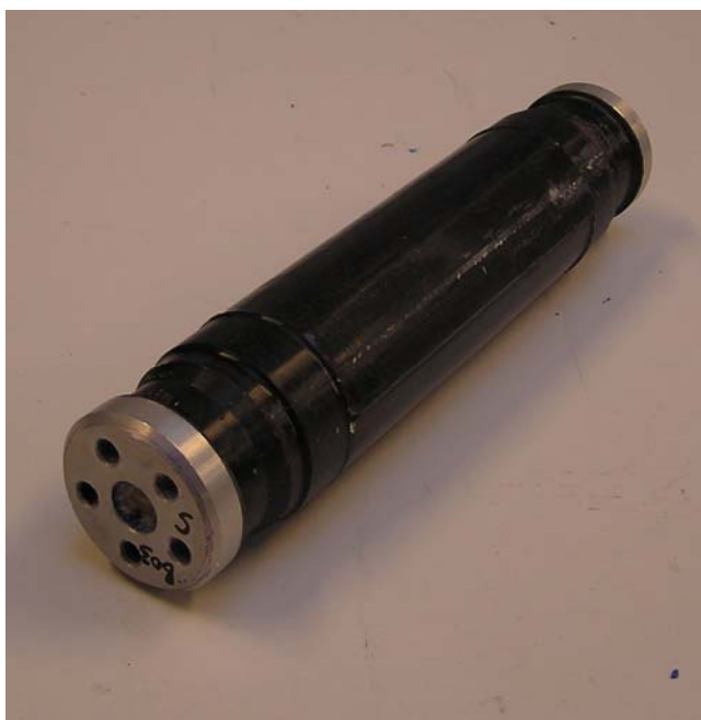
Obr. 9: Hotový výlisek po vyjmutí z formy
