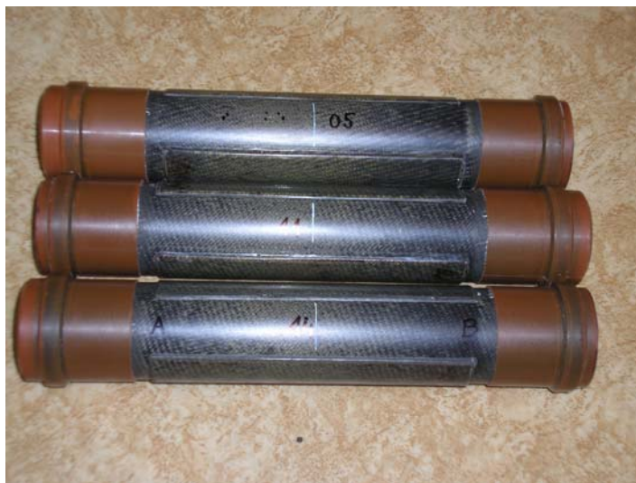
Obr. 9 Zkušební tělesa typu „Dvoukořen“
