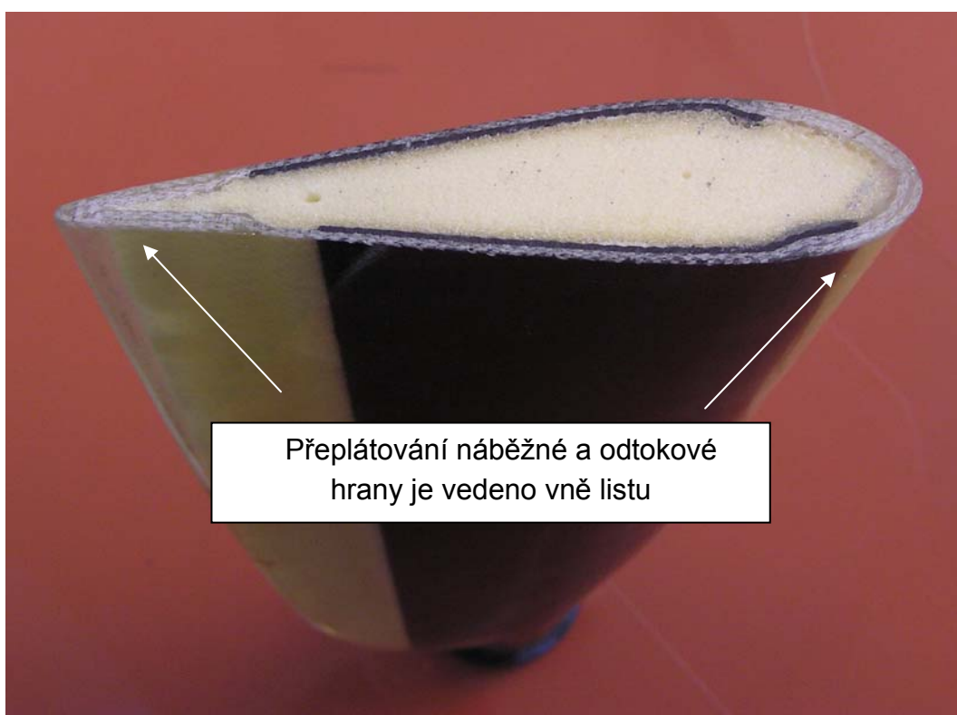
Obr. 8 Řez listem - viditelné je překrytí vrstev náběžné a odtokové hrany
