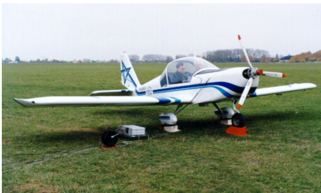
Obr. 5 Modální analýza vrtule na malém sportovním letounu s bezkontaktním přenosem signálu z tenzometrů na listech
