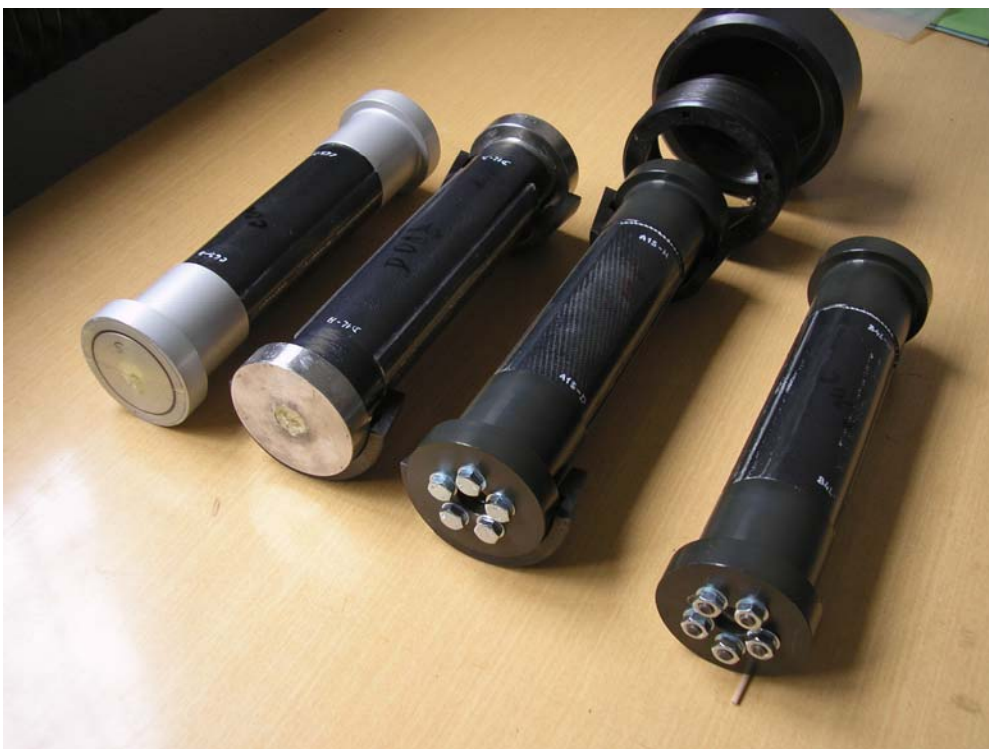
Obr. 10: Zkušební tělesa různých konstrukcí připravená ke statické zkoušce
