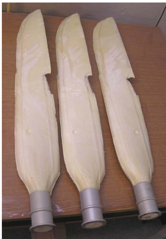
Obr. 3 Jádra listů z tvrdé PUR pěny
