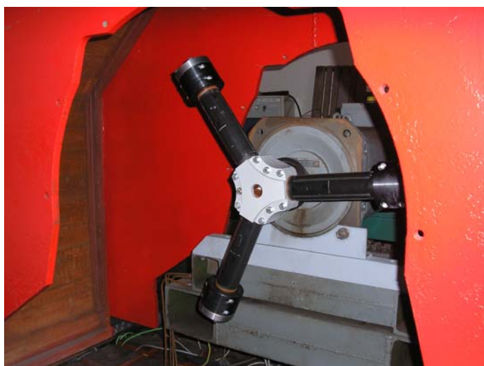
Obr. 10 Sestava „dvoukořenů“ pro zkoušku uložení přetočením na 200 % maximálních provozních odstředivých sil po dobu 1 hodiny
