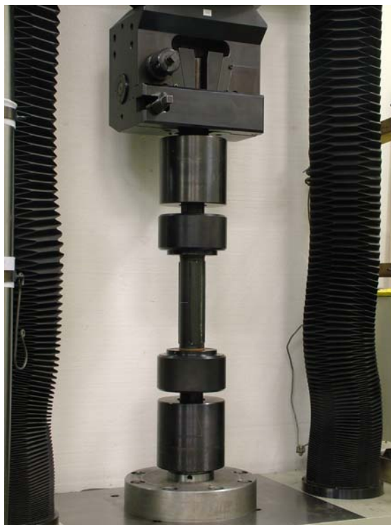
Obr. 11 Zkouška statické pevnosti realizovaná na zkušební útvary Pevnost letadel
