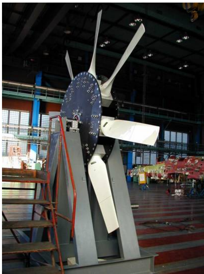
Obr. 2: Kompozitní rotor VZLÚ V934R pohonu aerodynamického tunelu
