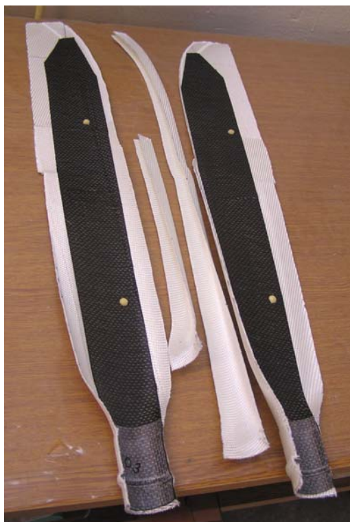
Obr. 2 Předlisky konstrukčních komponentů listu zhotovené vakuově / tepelným zhutněním tkanin výztuže
