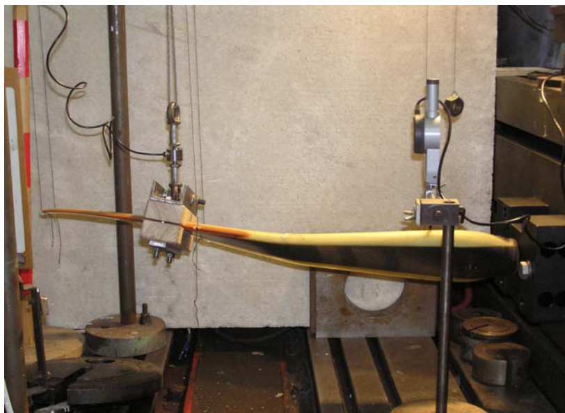
Obr. 12 Kompozitní list vrtule v okamžiku zlomu
