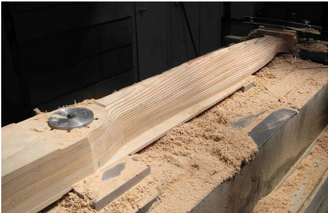
Obr. 7 Obrábění tvaru vrtule pro letoun Avia B.H.5 na běžné NC-frézce
