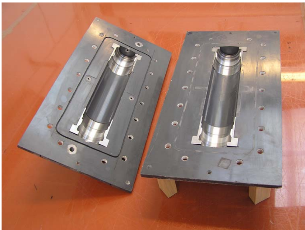
Obr. 7: Forma pro výrobu zkušebního tělesa kořenové části listu
