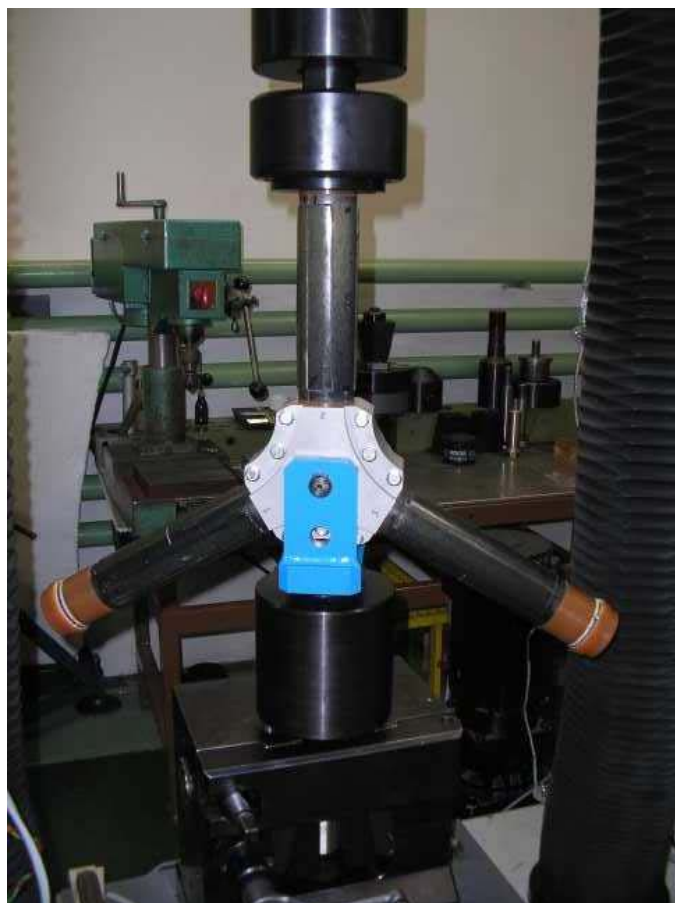
Obr. 14 Reálná sestava vrtulové hlavy pro zkoušku vytržení
