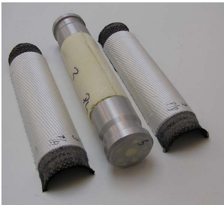
Obr. 8: Předlisky zkušebního tělesa před vložením do formy a infuzí matrice
