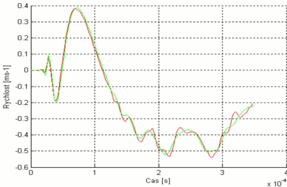
Obr. 13 Porovnání hodnot příčné rychlosti získané analytickým (červeně) a numerickým (zeleně) modelem.
