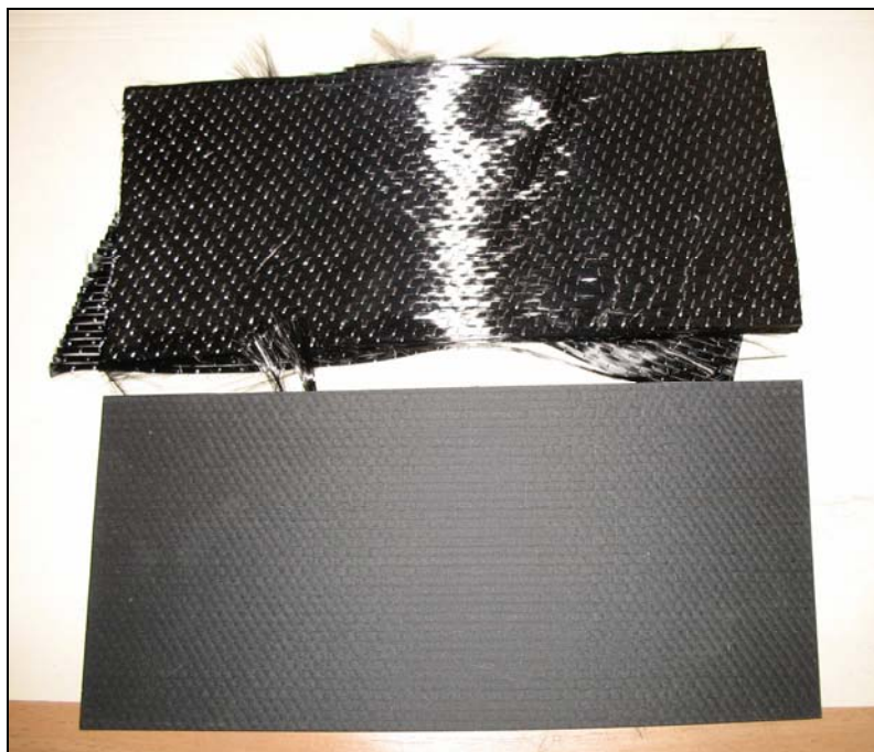
Obr. 3 - Vzorek kompozitové desky uhlík-epoxid před zpracováním (dole) a vyseparovaná vláknová výztuž po zpracování (nahore)
