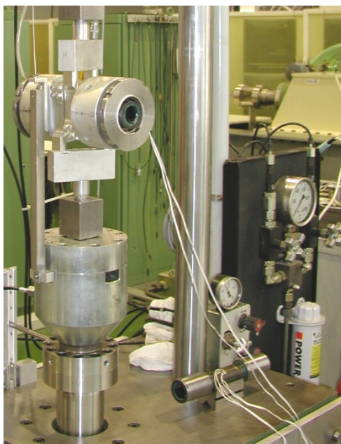
Obr. 3 – Ukázka zapojení při zkoušce krutem s kompenzací pomocí tenzometru na nezatíženém zkušebním tělese
