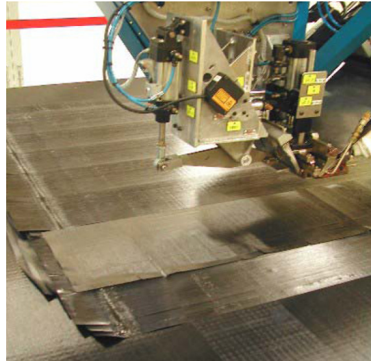
Obr. 1 - Pokládka vrstev strojem*
