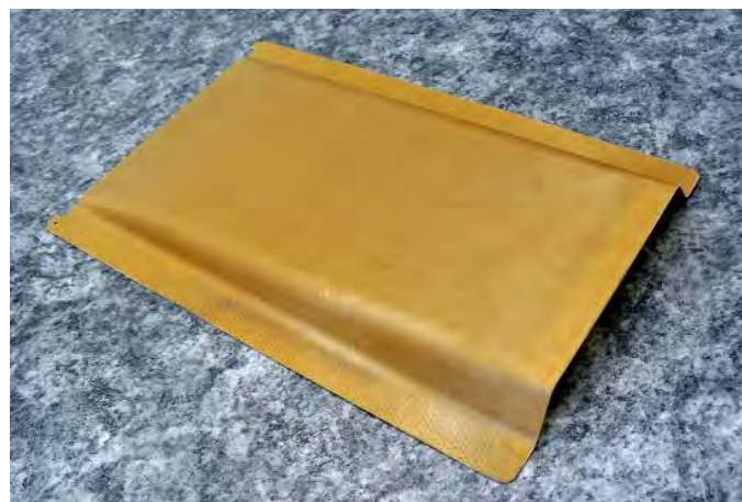
Obrázek 9. Díl zhotovený tvářením z Cetex System 3
