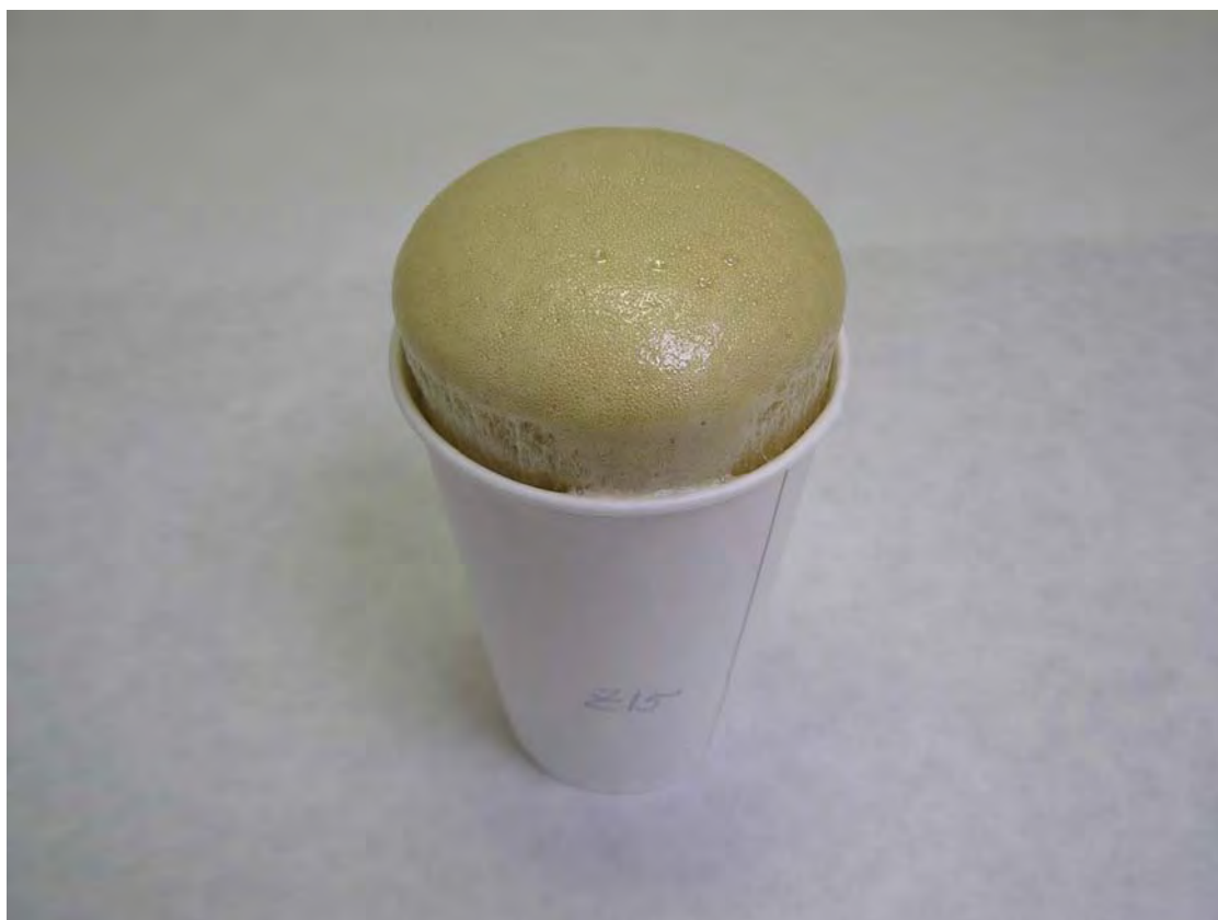
Obr. 5 – Pěna připravená pomocí vody, resp. CO 2 jako nadouvadla.
