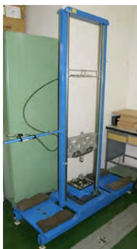
Obr. 13 Celkový pohled na padostroj - impaktor
