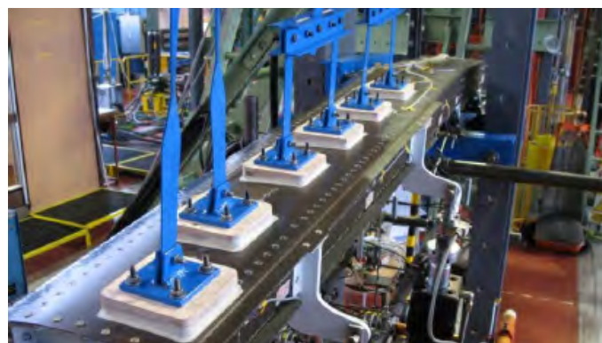
Obr. 6 Statická zkouška demonstrátoru křídla
