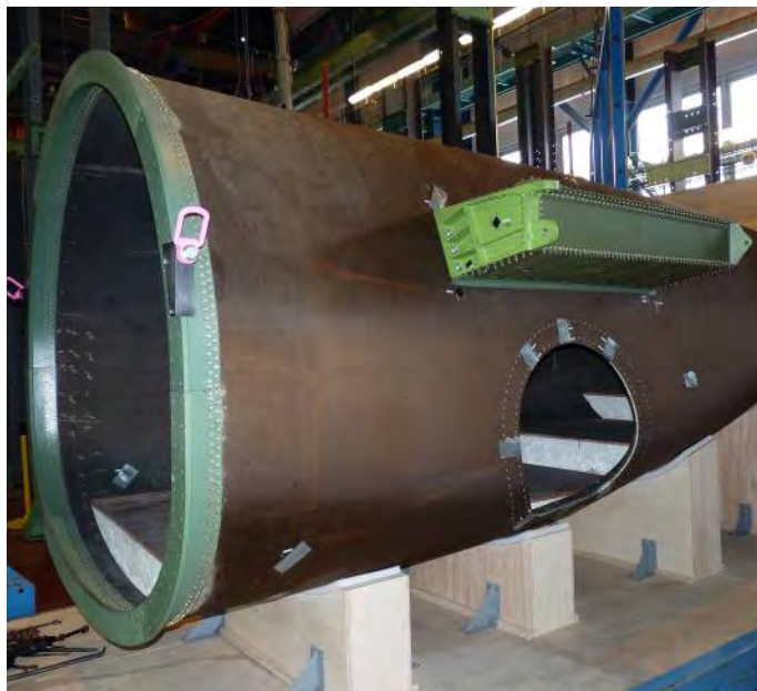
Obr. 2 Příprava zkoušky trupu bussines jetu
