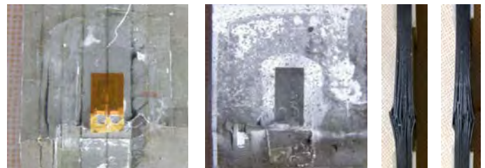
Obr. 23 Porucha v tlaku
