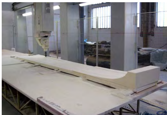
Obr. 2 Frézování negativní formy spodního potahu
