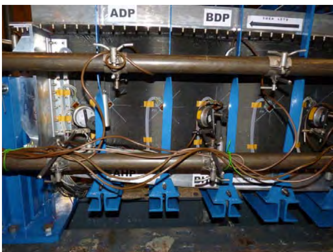
Obr. 32 Schéma snímače deformace MDI 81 a jejich umístění na měřeném objektu
