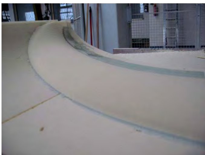
Obr. 5 Frézování horního tvaru pěnového jádra modelu
