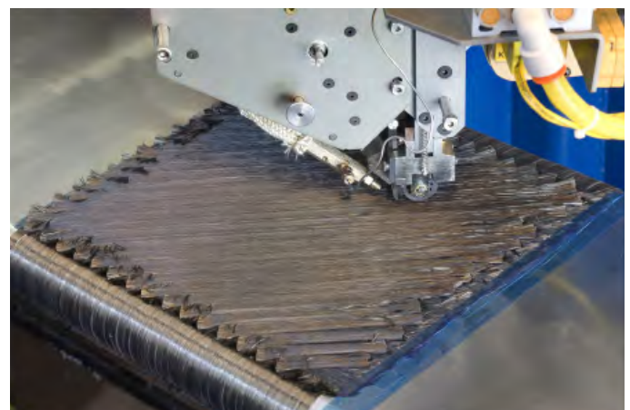
Obr. 10 Výroba preformy automatickým pokládáním suché pásky vláken
