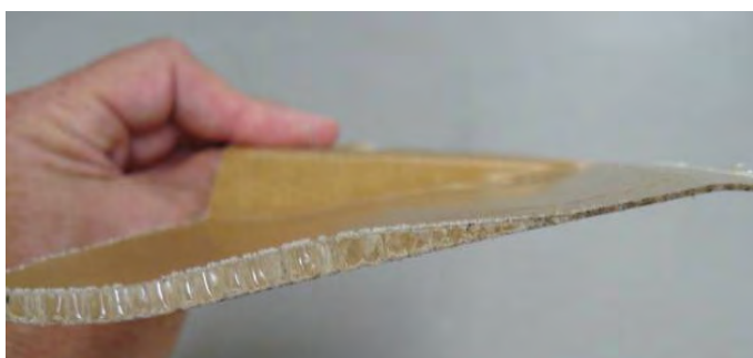
Obrázek 8. Řez dílem ze sendviče Cetex System 3
