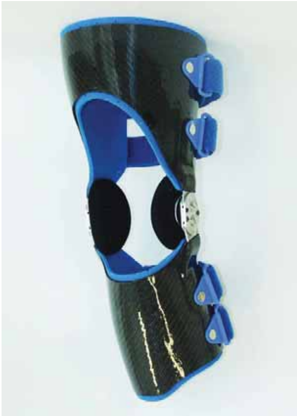
Obr. 35 Uhlíková kolenní ortéza vyrobená LF Technologií fy ING Corporation. Nahrazení původně použitého prepregu došlo ke snížení ceny ortézy a především k bezpečnějšímu zachycení kloubu ortézou do laminátu, viz. detail.
