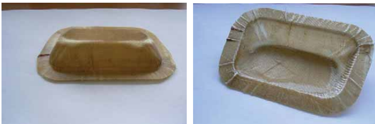
Obr. 41 Vzorek tenké prostorové skořepiny vytvořený pod vakuem ze skelné tkaniny a vrstvy fólie PA 11 LF Technologii. Vlevo lícová část, vpravo rub dílu. Délka vzorku je cca 100 mm.
