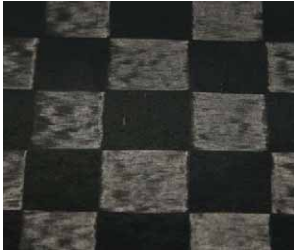
Obr. 34 Aplikace Letoxit LFX 035 na uhlíkovou tkaninu TeXtreme fy Oxeon
