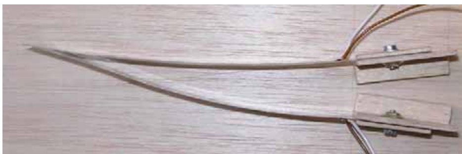
Obr. 13 Demonstrátor bezzávěsového křídélka vychylovaného piezoaktuátory, maximální výchylka
