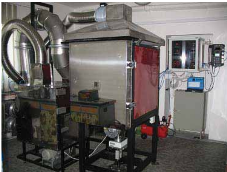
Obr. 1 - experimentální systém pro teplotní (pyrolýzní) rozklad vláknových termosetických kompozitních materiálů
