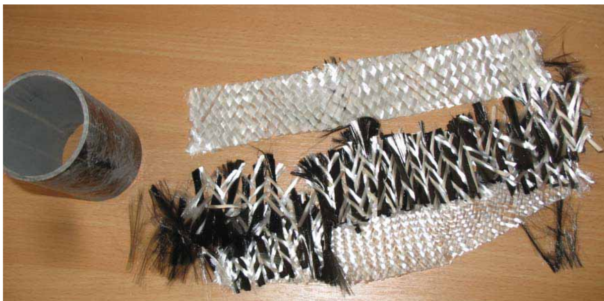
Obr. 15 – rozklad jednotlivých vrstev obnovené vláknové výztuže (tkanin)
