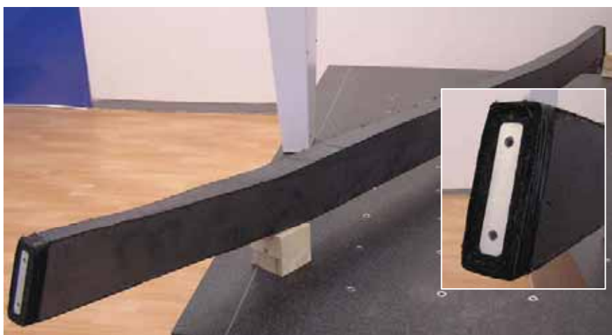
Obr. 10 Navrstvená "suchá" skladba nosníku
