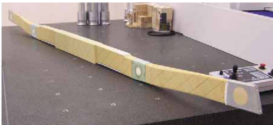
Obr. 9 Jádno nosníku 1:1 z konstrukční pěny ALCAN AIREX®
