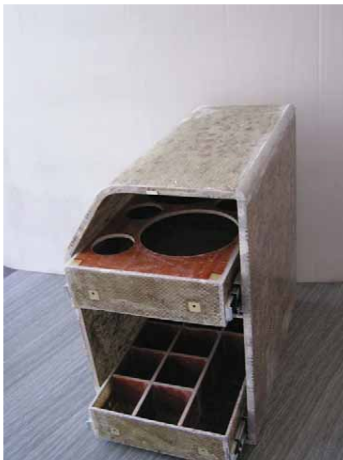
Obr. 29 Refreshment kabinet před nátěrem. Je patrná voštinová stavba dílu a inserty pro spojování dílů a uchycení závěsů
