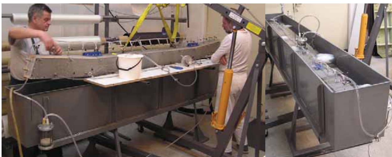
Obr. 11 Proces RTM. Vpravo: tlumení exotermní polymerační reakce pojivového systému Araldite® 5052 ve vodní lázni
