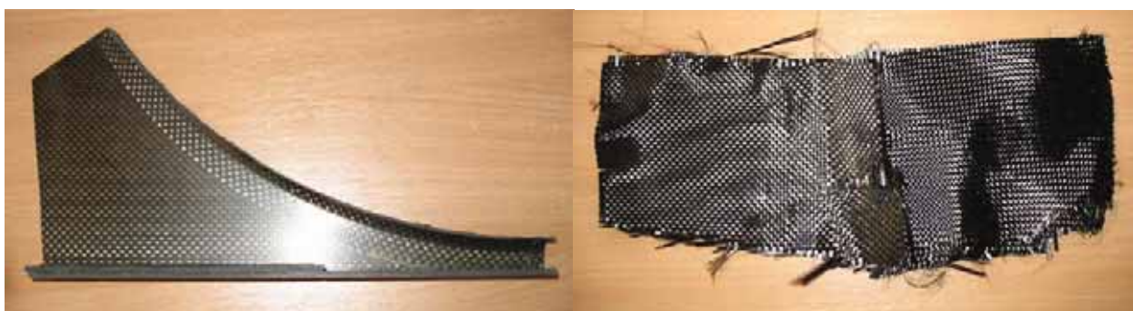
Obr. 2 – ukázka kompozitního dílu z materiálu typu uhlík-bismaleimid a obnovených uhlíkových vláken (tkaniny)
