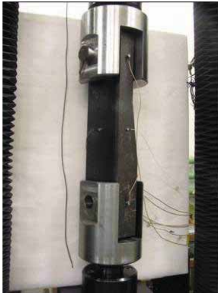
Obr. 7 Statická tahová zkouška na zkušebním stroji TIRA. Jsou patrná čidla vyhodnocující stav vzorku z hlediska akustické emise. Vpravo vzorek po zkoušce
