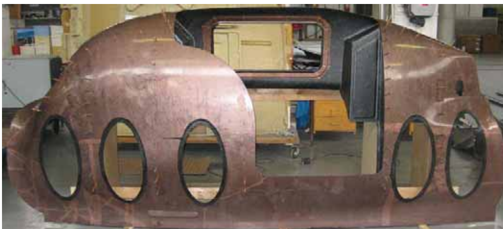
Obr. 4. Lepená sestava skořepiny podvozkové gondoly a žeber
