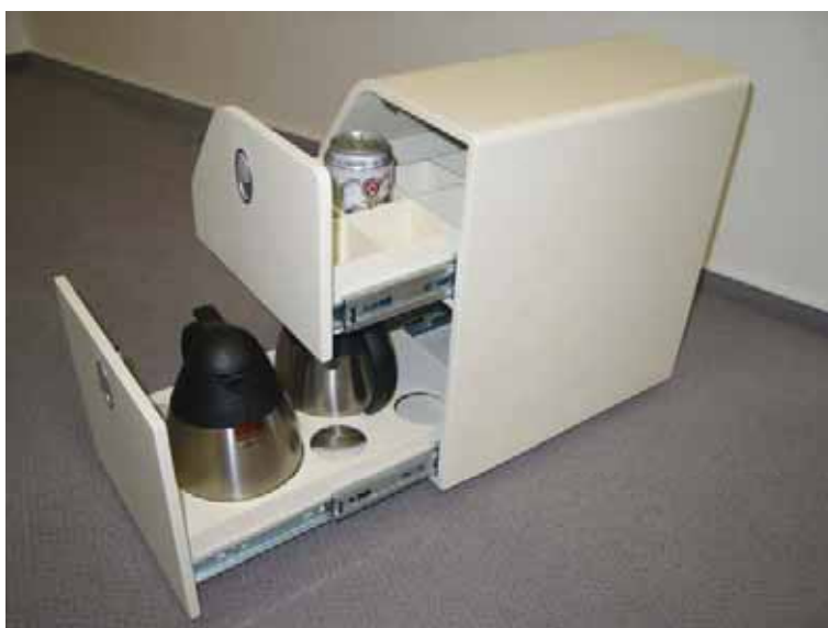
Obr. 28 Refreshment kabinet opatřený nátěrem. Díl byl dimenzován pro přetížení 2G při plném naložení plechovkami a konvicemi
