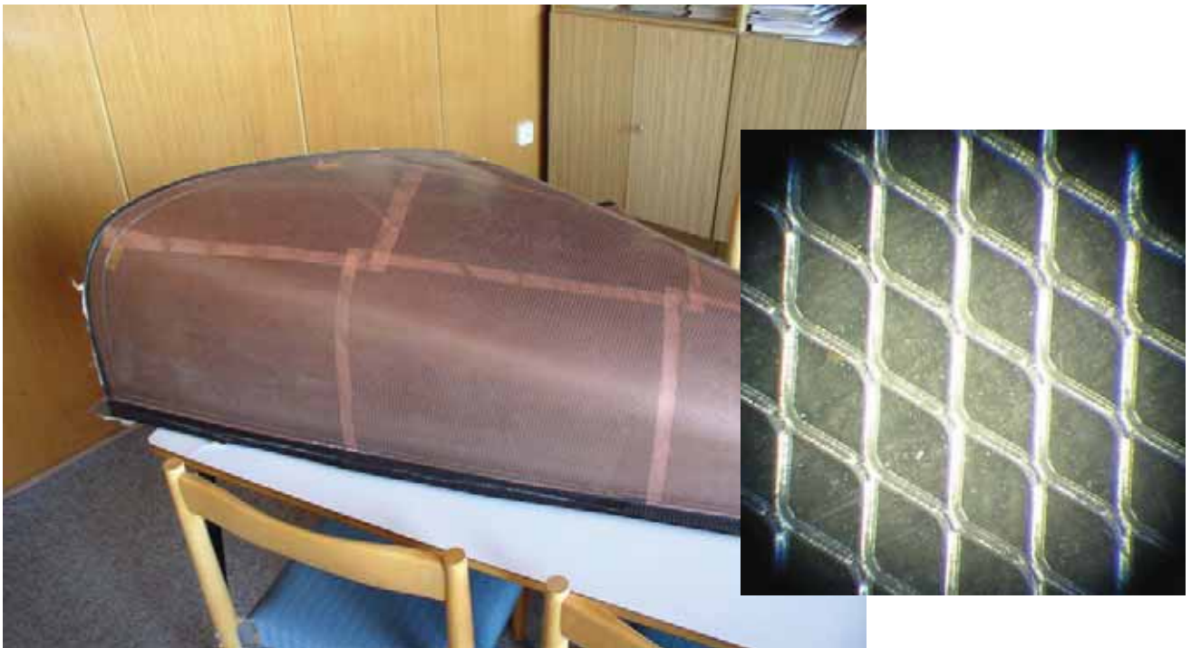
Obr. 20 Použití měděné mřížky jako semipregu na uhlíkovém kompozitu pro prototyp EV 55. Vlevo pak detail struktury mřížky v epoxidové pryskyřici.
