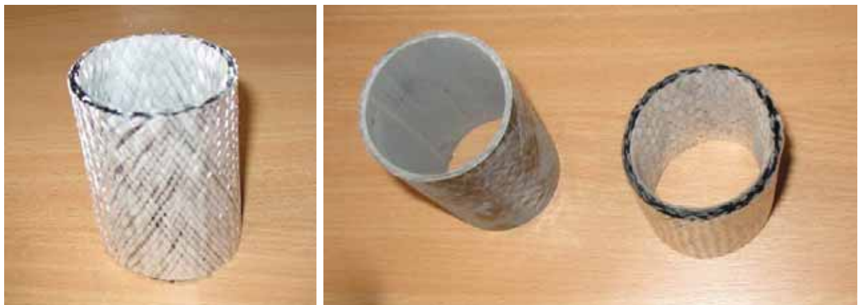
Obr. 14 – obnovená vláknová výztuž – kombinace skelné a uhlíkové tkaniny
