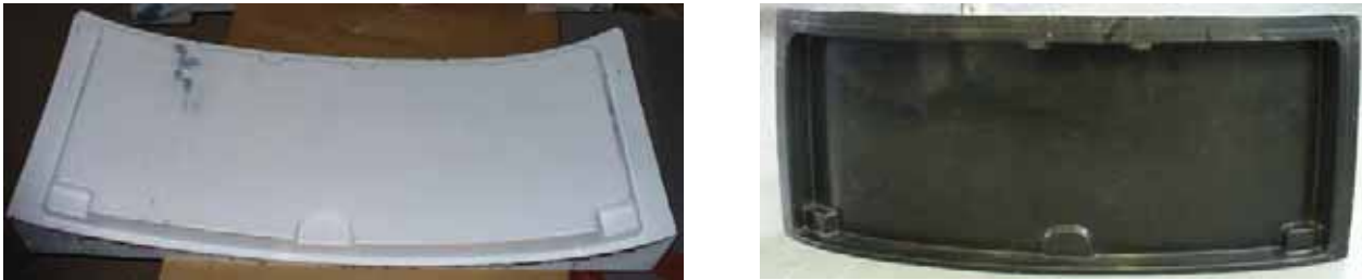
Obr. 3. Maketa vnitřní skořepiny dveří a forma na ní vyrobená
