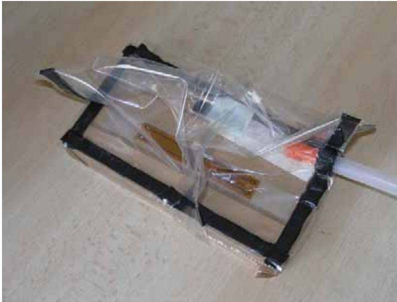
Obr. 9 Piezoaktuátor MFC přilepený na laminátovou destičku v přípravku na podtlakové přitisknutí, před odčerpáním vzduchu
