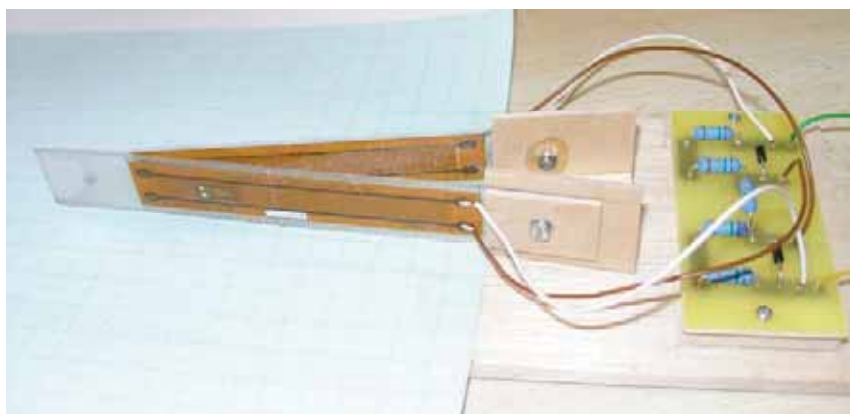
Obr. 1 Celkový pohled na demonstrátor bezzávěsového křídélka vychylovaného piezoaktuátory
