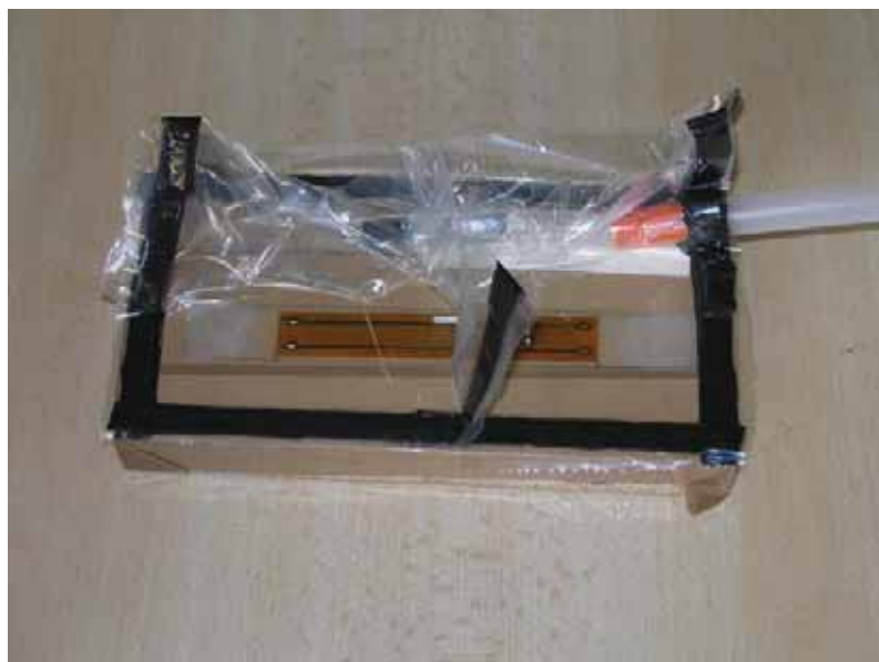
Obr. 10 Piezoaktuátor MFC přilepený na laminátovou destičku v přípravku na podtlakové přitisknutí, po odčerpání vzduchu
