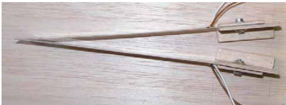
Obr. 12 Demonstrátor bezzávěsového křídélka vychylovaného piezoaktuátory, neutrální poloha
